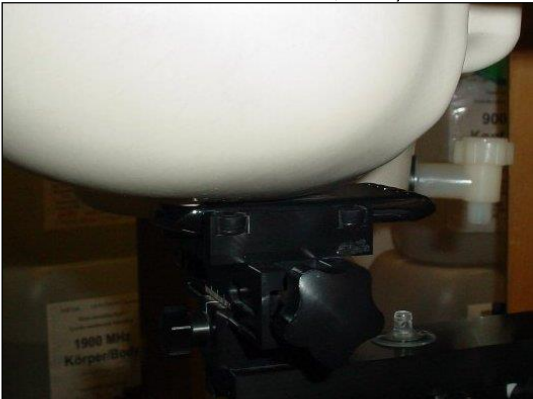
Photo 14: Position d'essai main droite, contre la joue
