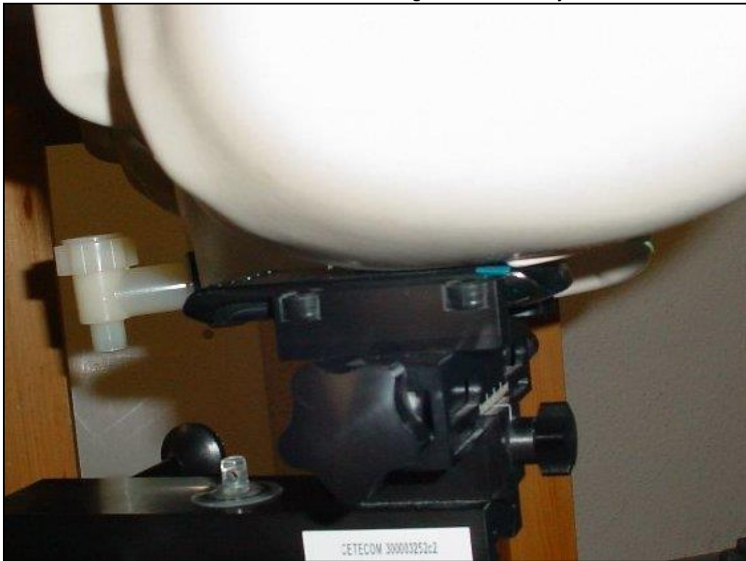
Photo 10: Position d'essai main gauche, contre la joue
