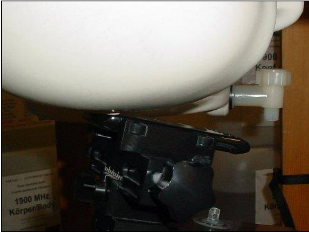
Photo 17: Position d'essai main droite, incliné 15°
