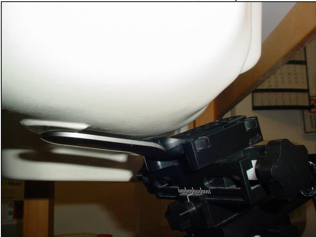
Photo 16: Position d'essai main droite, contre la joue
