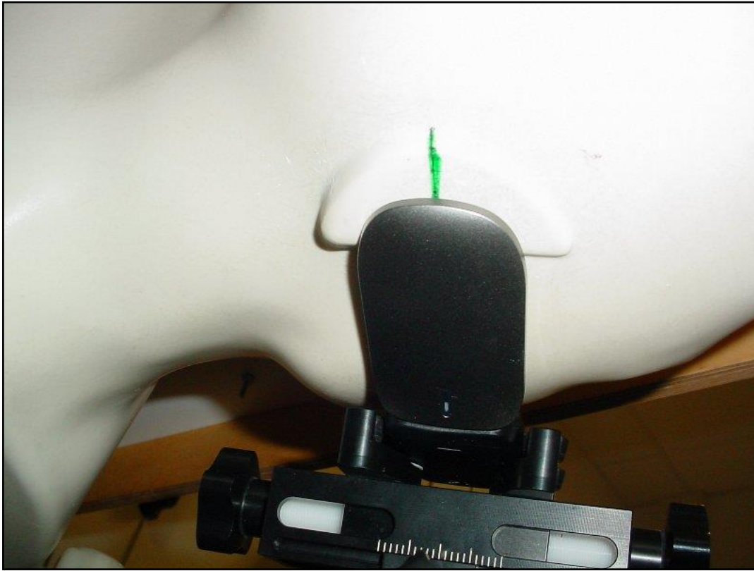
Photo 18: Position d'essai main droite, incliné 15°
