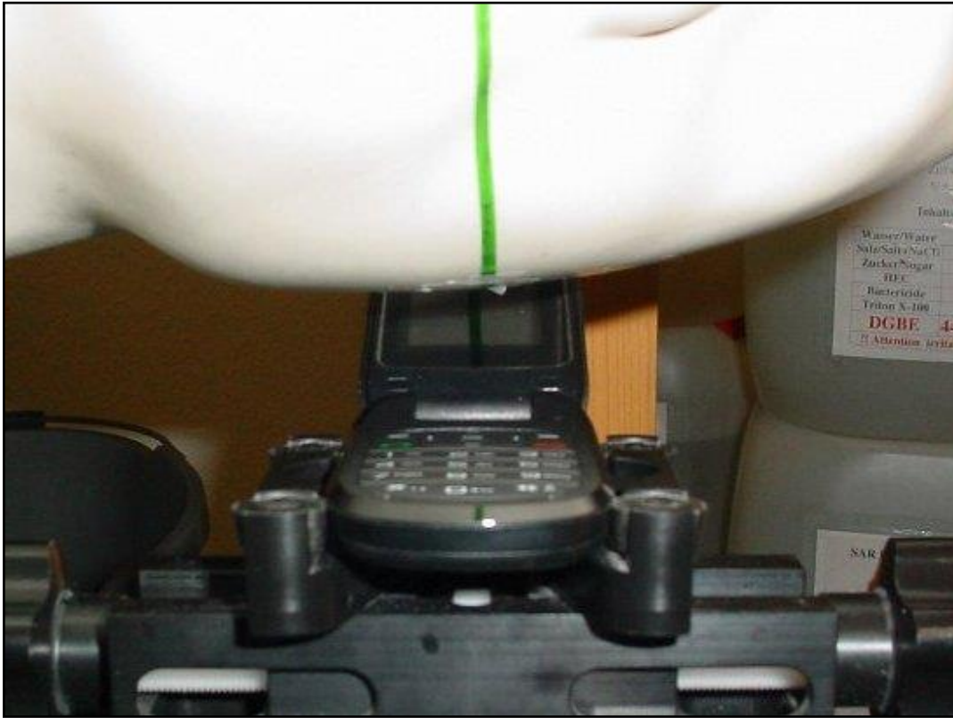
Photo 14: Position d'essai main gauche, incliné 15°
