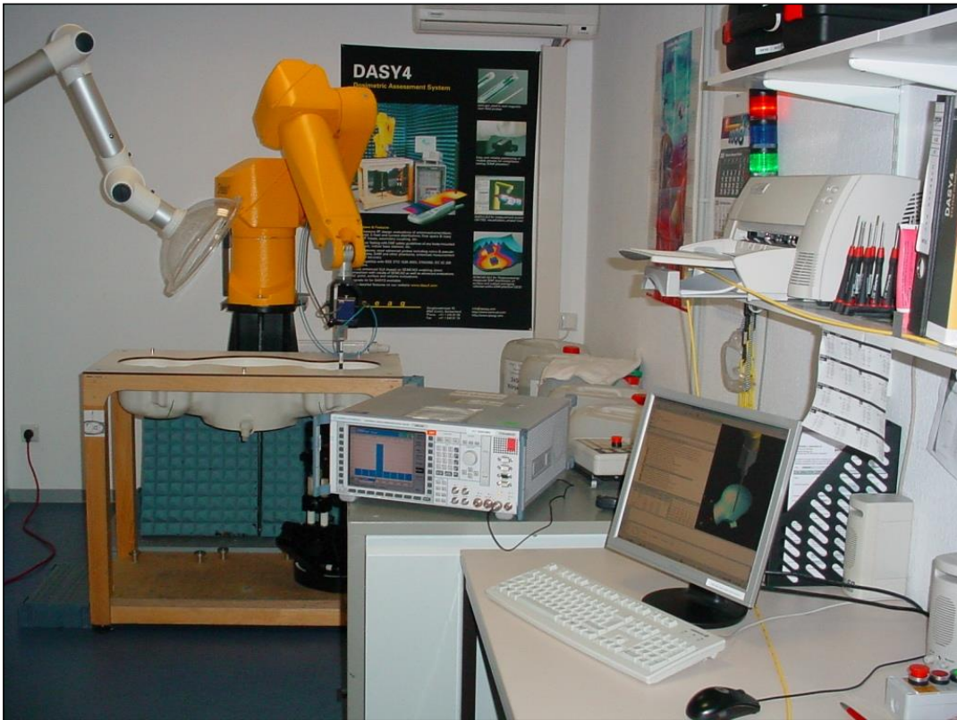
Photo 1: Banc d'essai DASY 4
