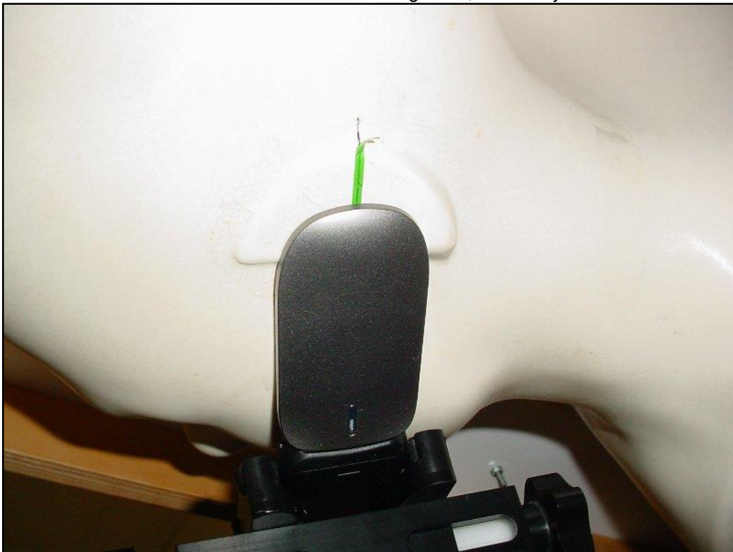
Photo 12: Position d'essai main gauche, contre la joue
