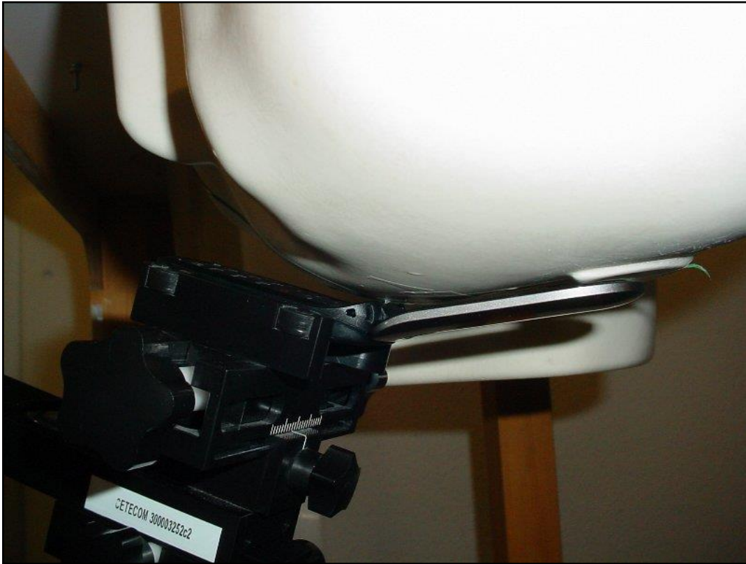
Photo 12: Position d'essai main gauche, contre la joue
