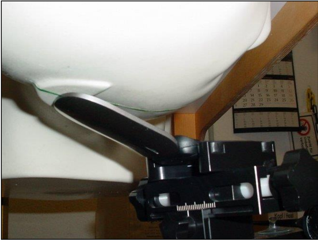
Photo 19: Position d'essai main droite, incliné 15°
