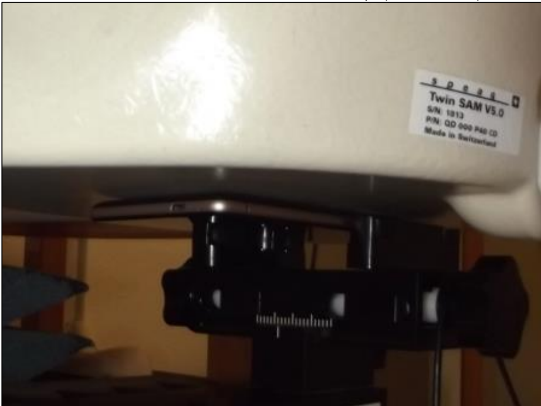
Photo 8: Position d'essai face arrière contre le corps (distance 0 mm)
