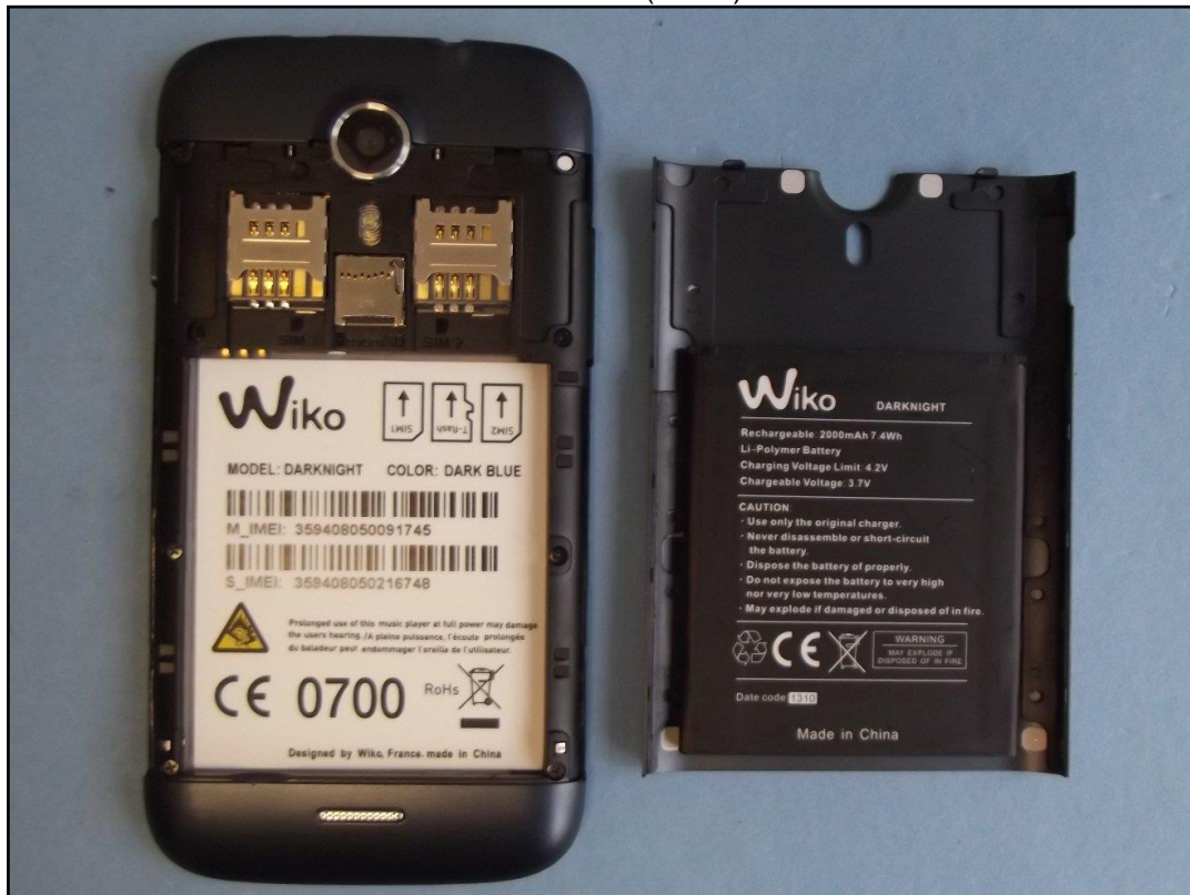
Photo 6: EST – vue arrière (ouvert) sans batterie
