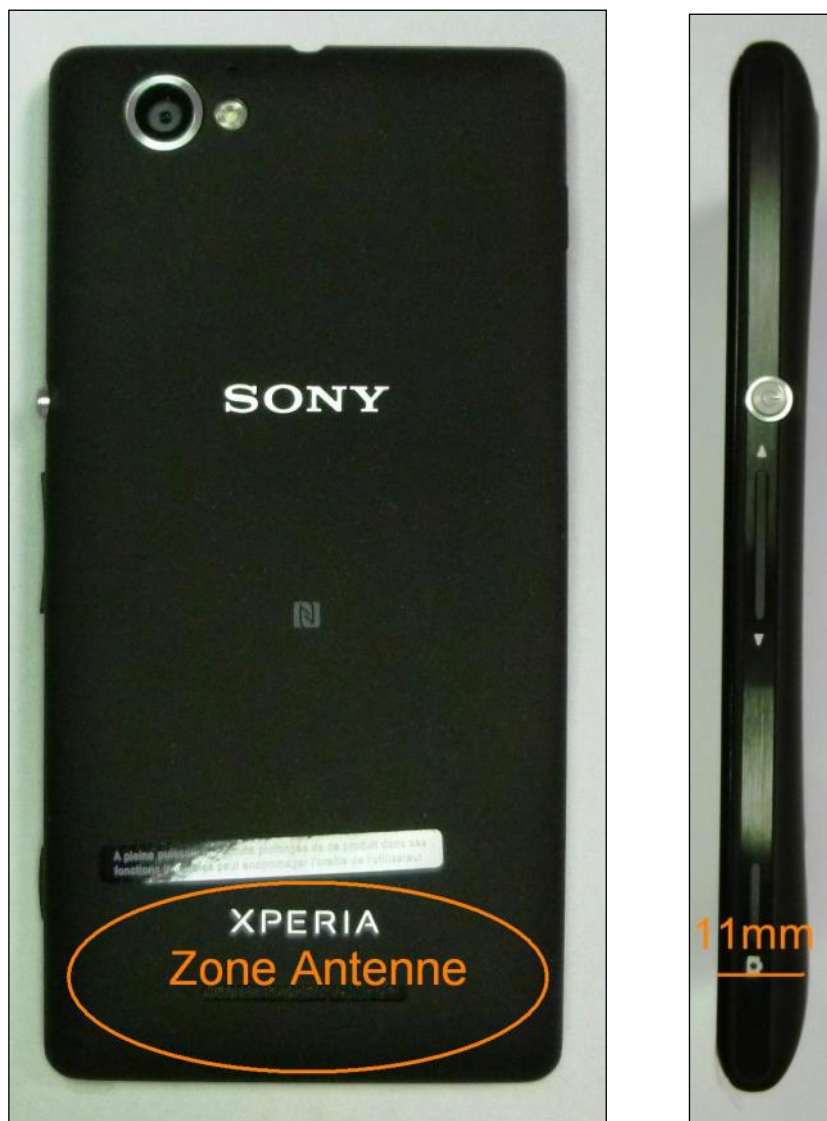
Fig. 17: Emplacement de l'antenne et épaisseur de l'équipement dans cette zone
