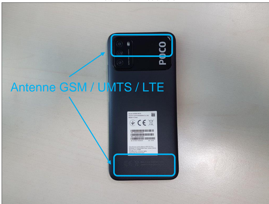
Photo 4: EST – vue arrière
