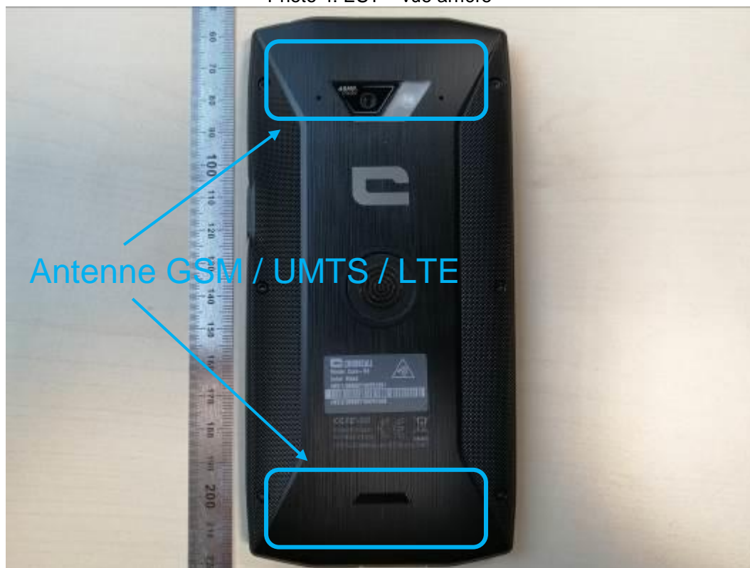
Photo 4: EST – vue arrière
