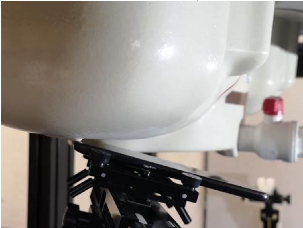
Photo 15: Position d'essai main droite, incliné 15°
