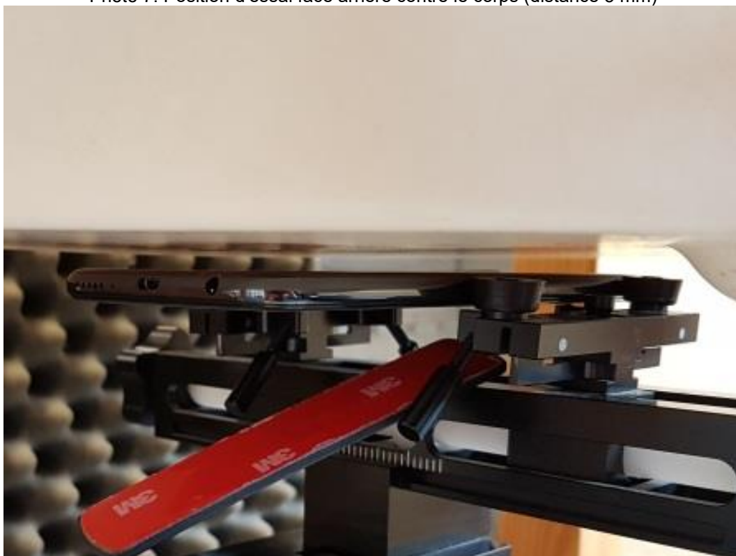
Photo 8: Position d'essai face du côté gauche contre le corps (distance 5 mm)
