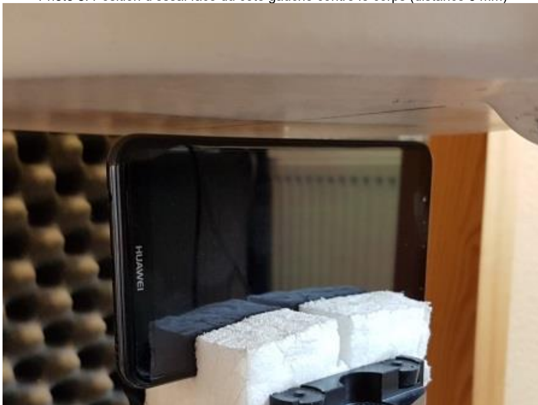
Photo 8: Position d'essai face du côté gauche contre le corps (distance 5 mm)
