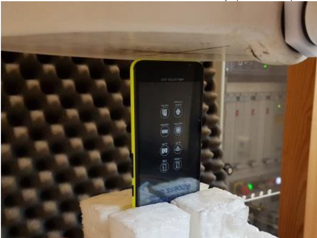
Photo 14: Position d'essai face du dessous contre le corps (distance 5 mm)
