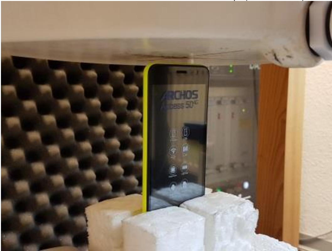
Photo 14: Position d'essai face du dessous contre le corps (distance 5 mm)
