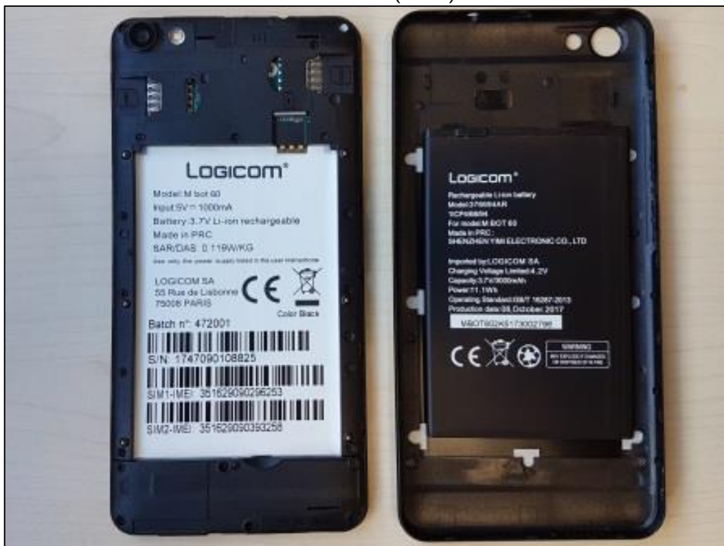
Photo 6: EST – vue arrière (ouvert) sans batterie
