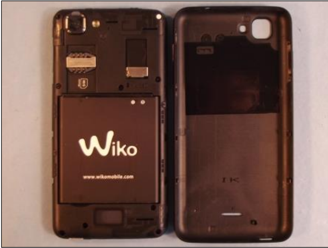
Photo 5: EST – vue arrière (ouvert) avec batterie
