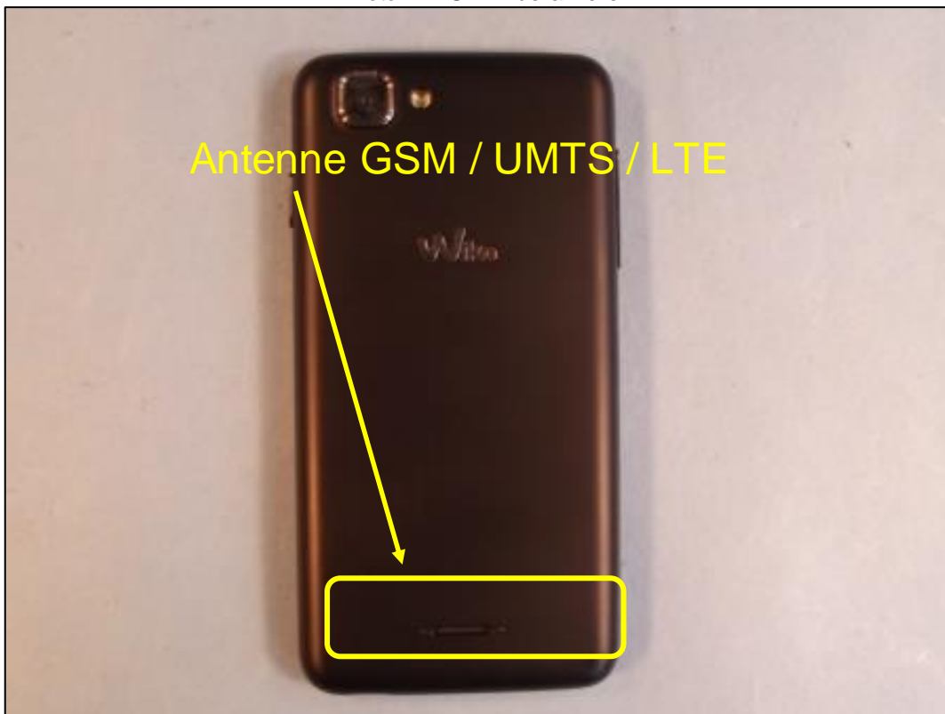
Photo 4: EST – vue arrière
