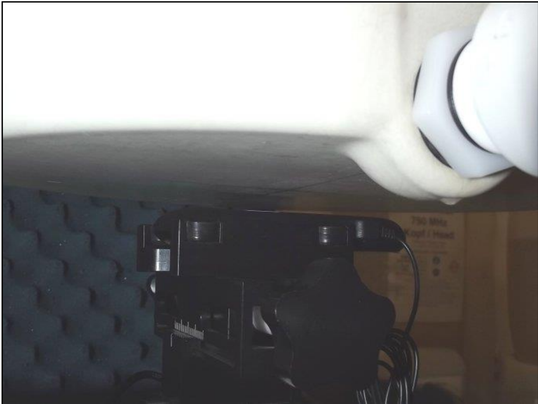
Photo 11: Position d'essai face arrière contre le corps (distance 10 mm)
