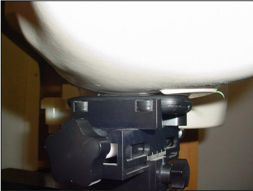
Photo 10: Position d'essai main gauche, contre la joue
