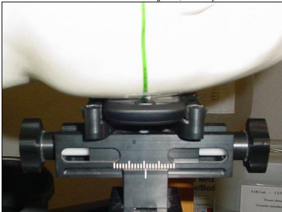
Photo 8: Position d'essai main gauche, contre la joue
