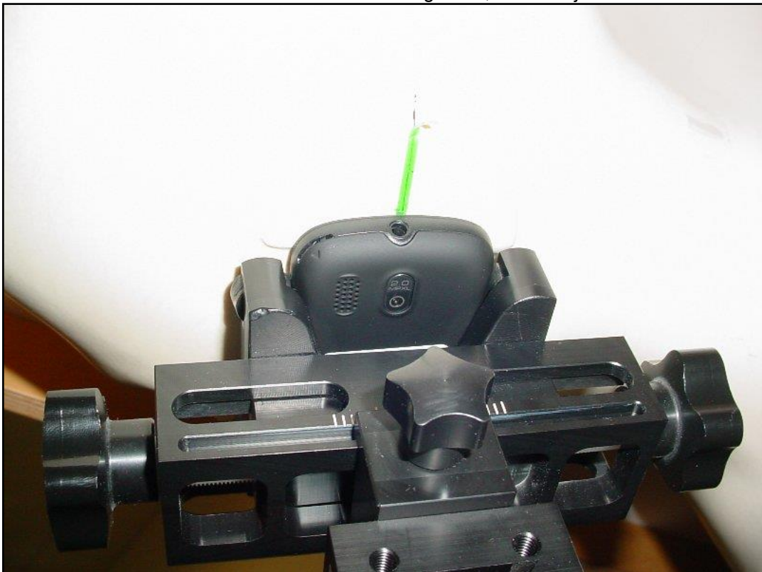
Photo 10: Position d'essai main gauche, contre la joue
