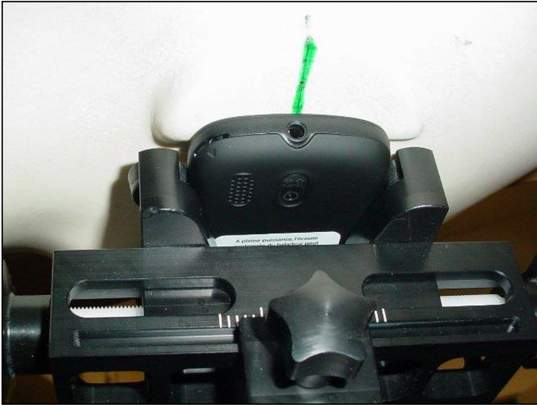
Photo 16: Position d'essai main droite, incliné 15°
