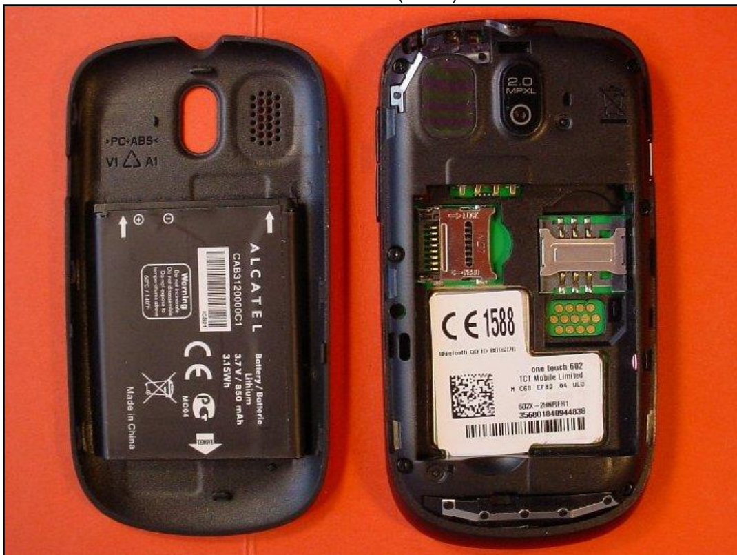
Photo 6: EST – vue arrière (ouvert) sans batterie
