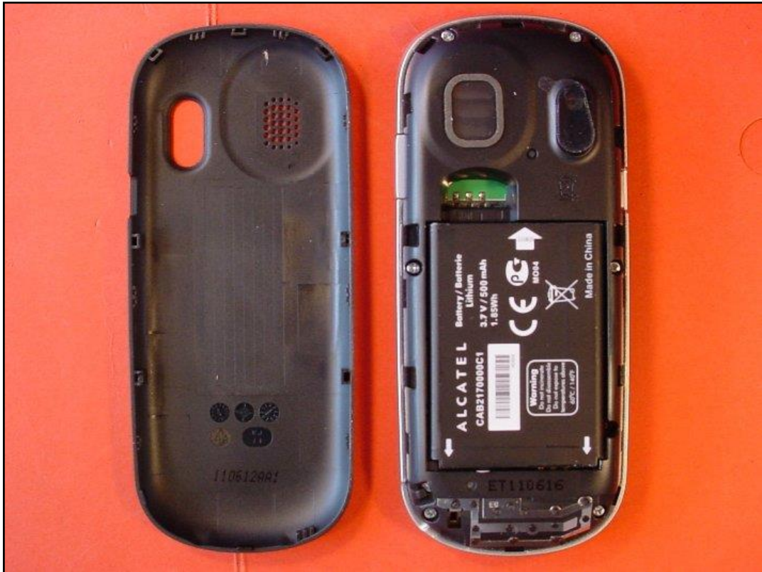
Photo 5: EST – vue arrière (ouvert) avec batterie
