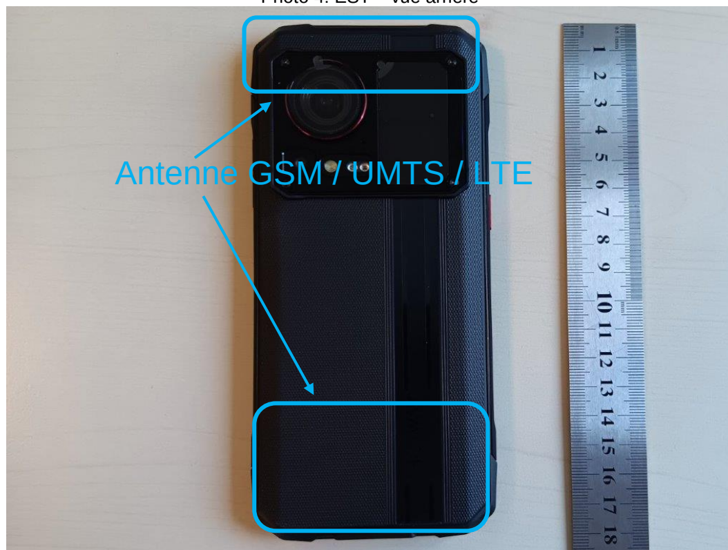
Photo 4: EST – vue arrière
