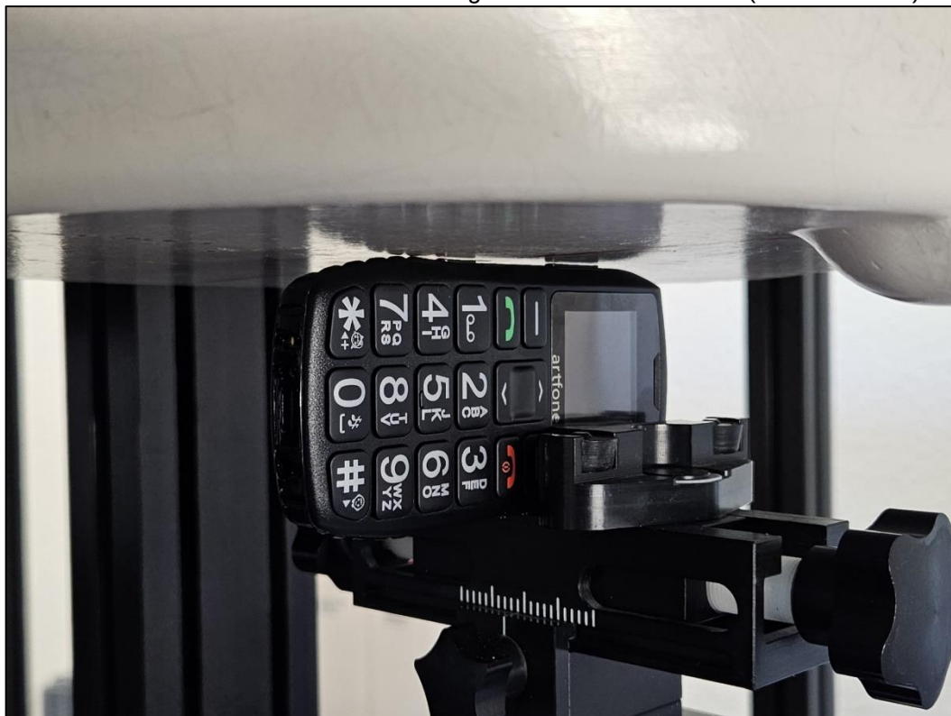
Photo 11: Position d'essai face du côté gauche contre le membre (distance 0 mm)
