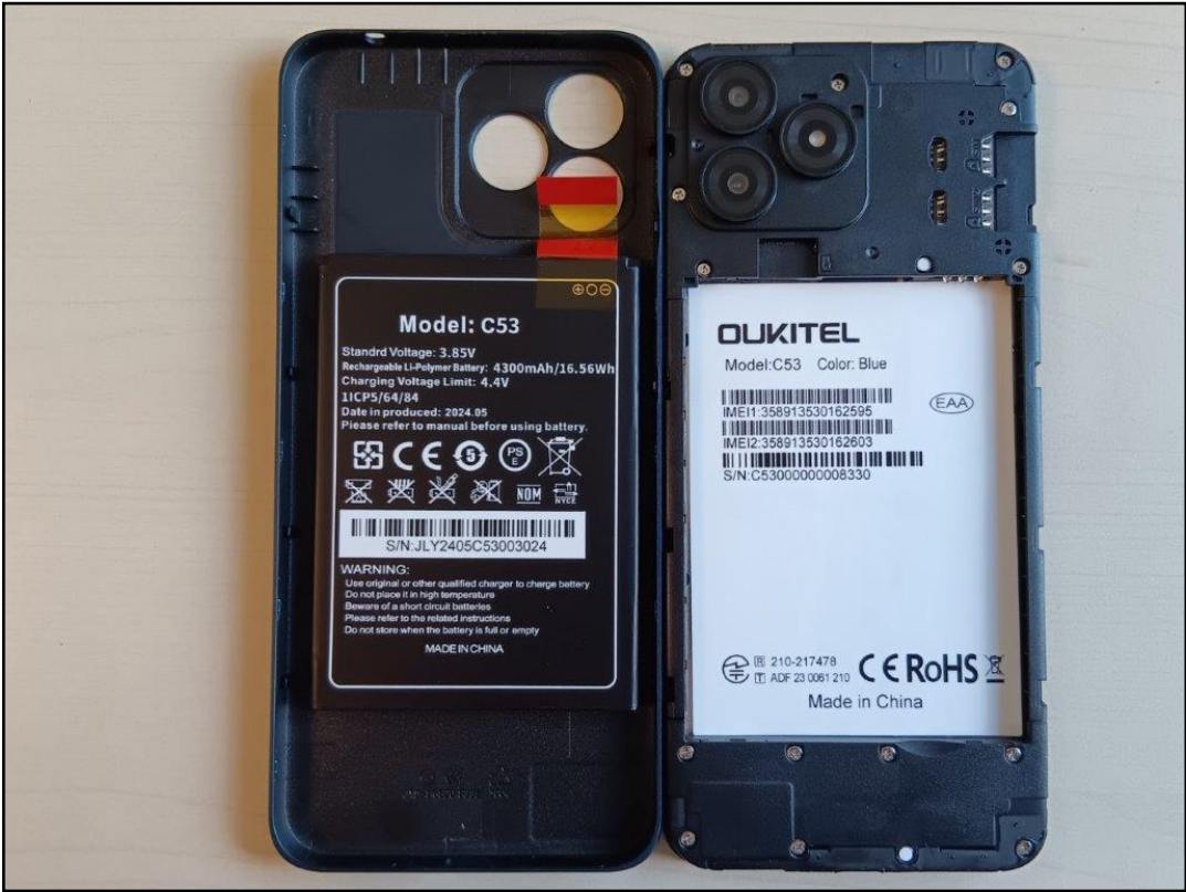
Photo 5: EST – vue arrière (ouvert) avec batterie
