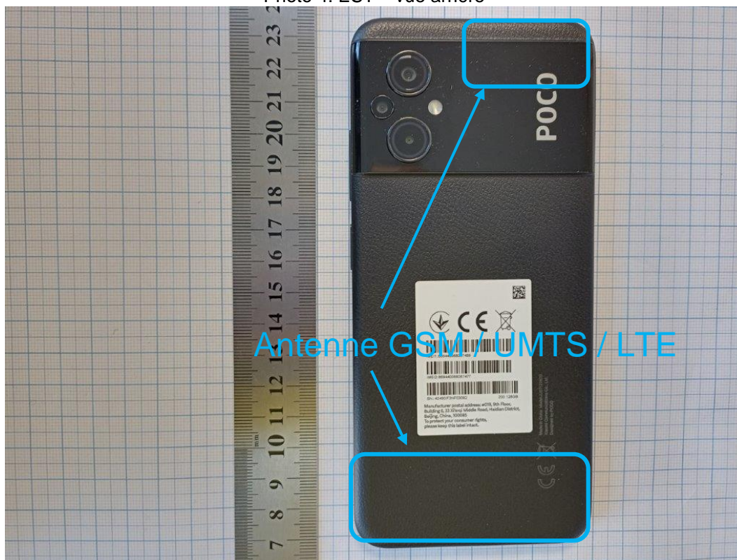
Photo 4: EST – vue arrière
