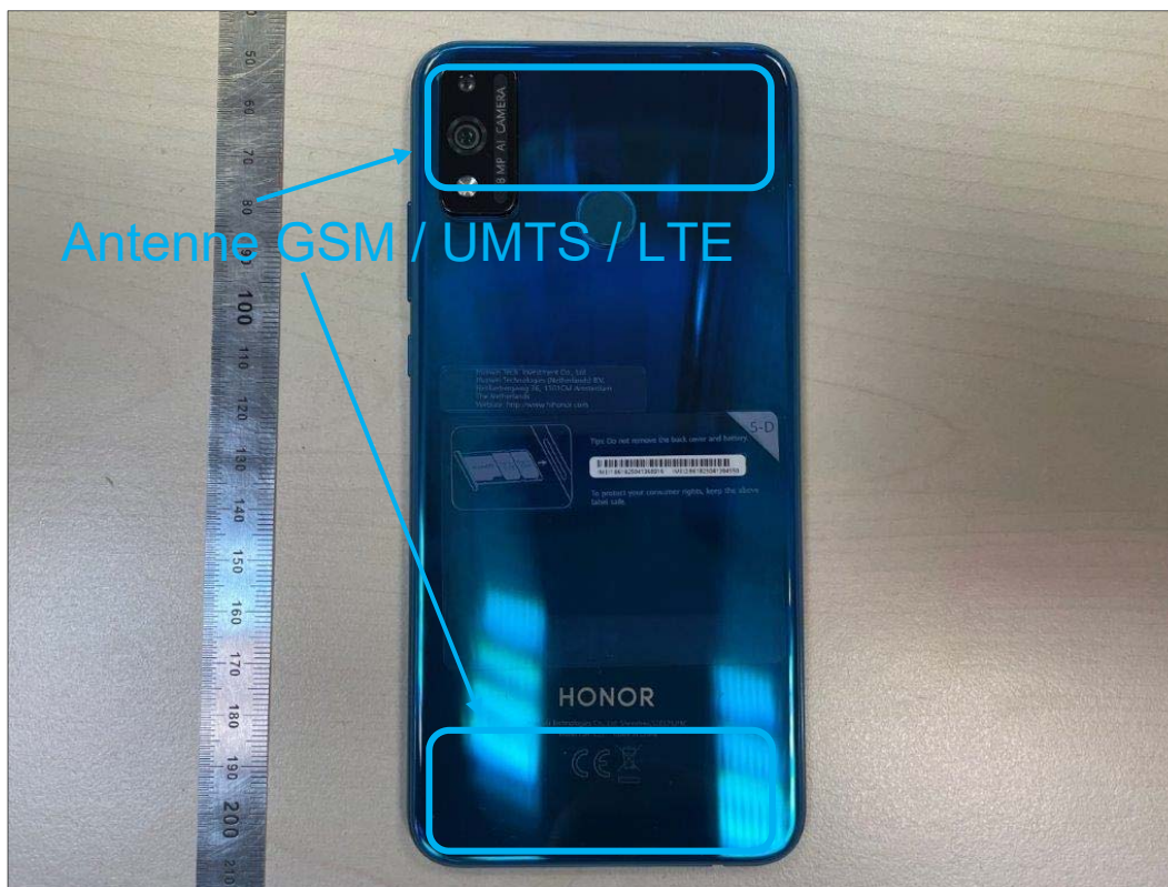
Photo 4: EST – vue arrière
