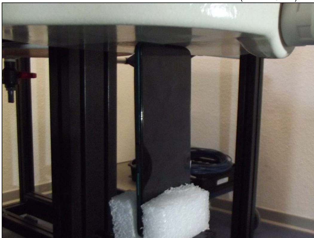
Photo 11: Position d'essai face du dessous contre le membre (distance 0 mm)
