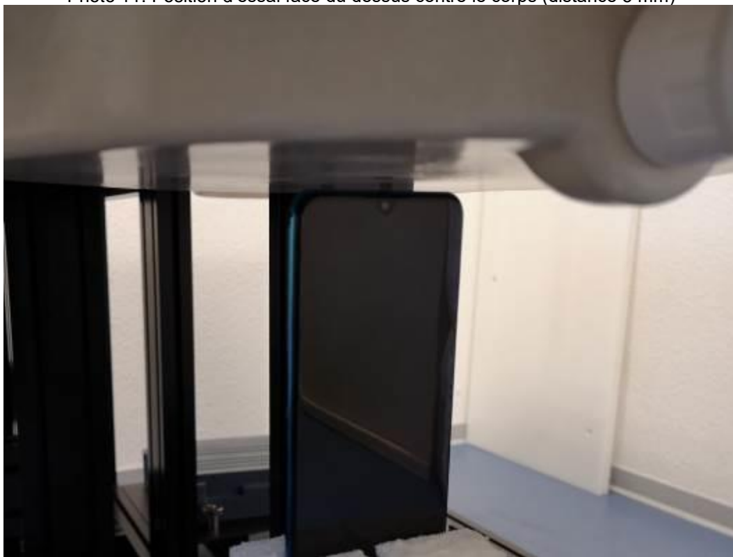
Photo 12: Position d'essai face du dessous contre le corps (distance 5 mm)
