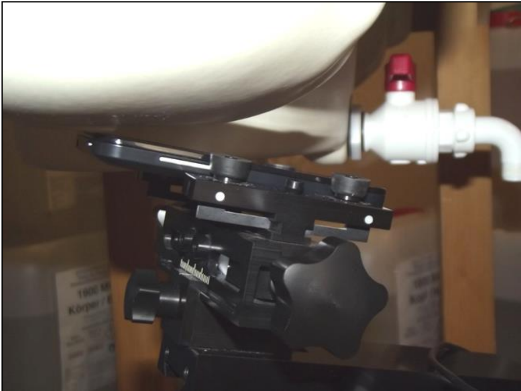
Photo 17: Position d'essai main droite, incliné 15°
