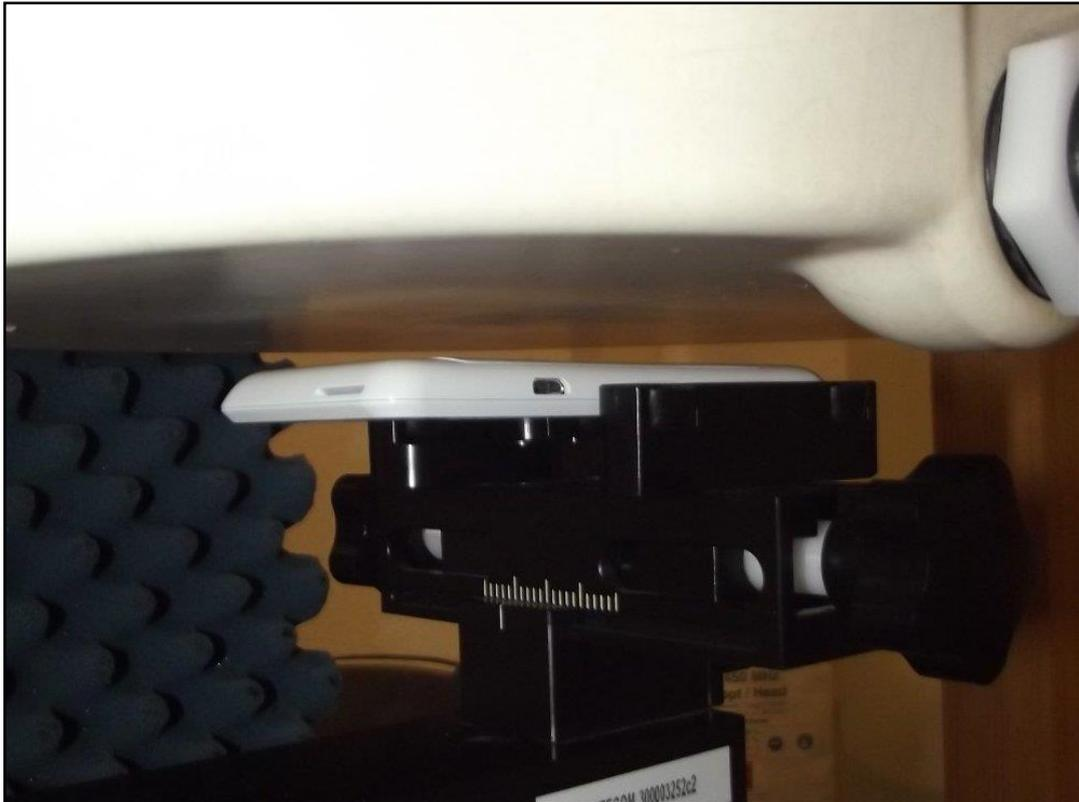
Photo 12: Position d'essai face arrière contre le corps (distance 25 mm)
