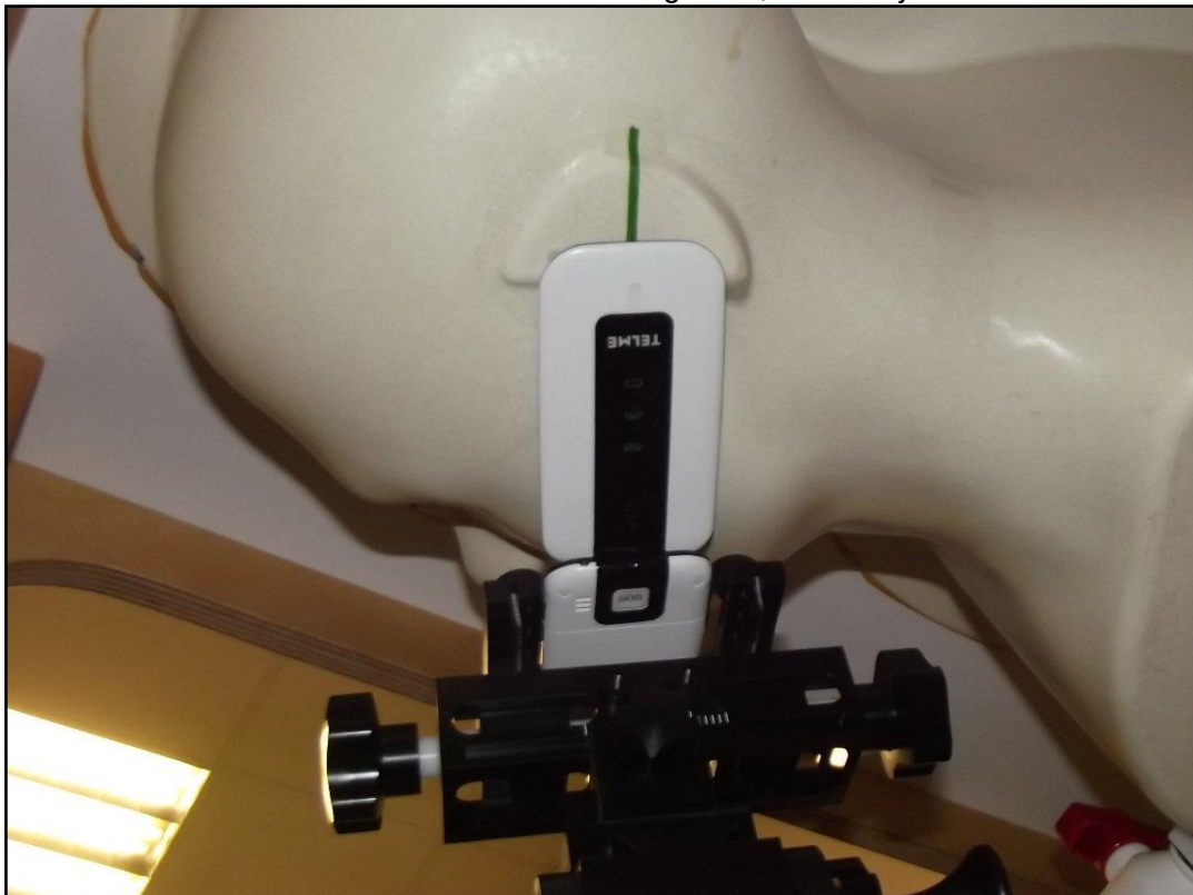
Photo 12: Position d'essai main gauche, contre la joue
