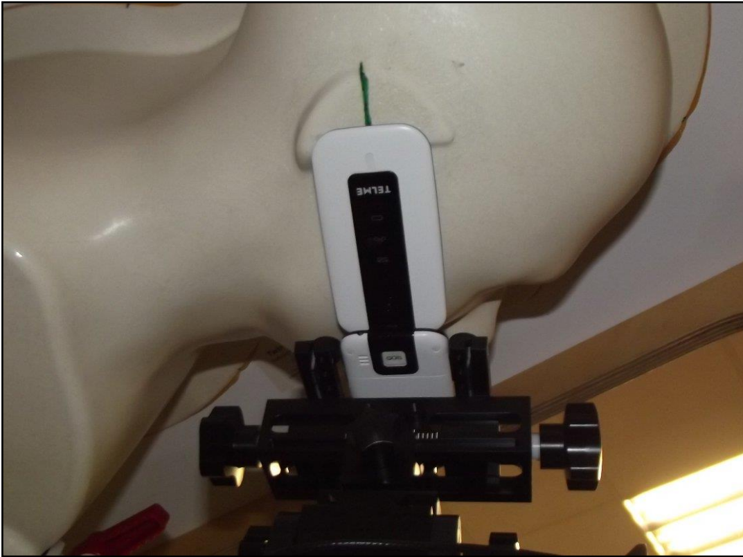
Photo 18: Position d'essai main droite, incliné 15°
