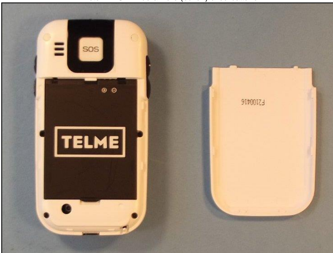
Photo 8: EST – vue arrière (ouvert) sans batterie
