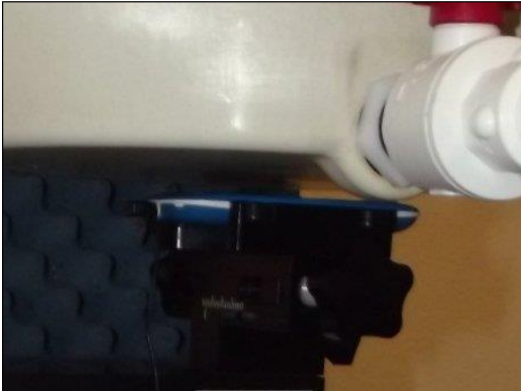
Photo 11: Position d'essai face avant contre le corps (distance 10 mm)
