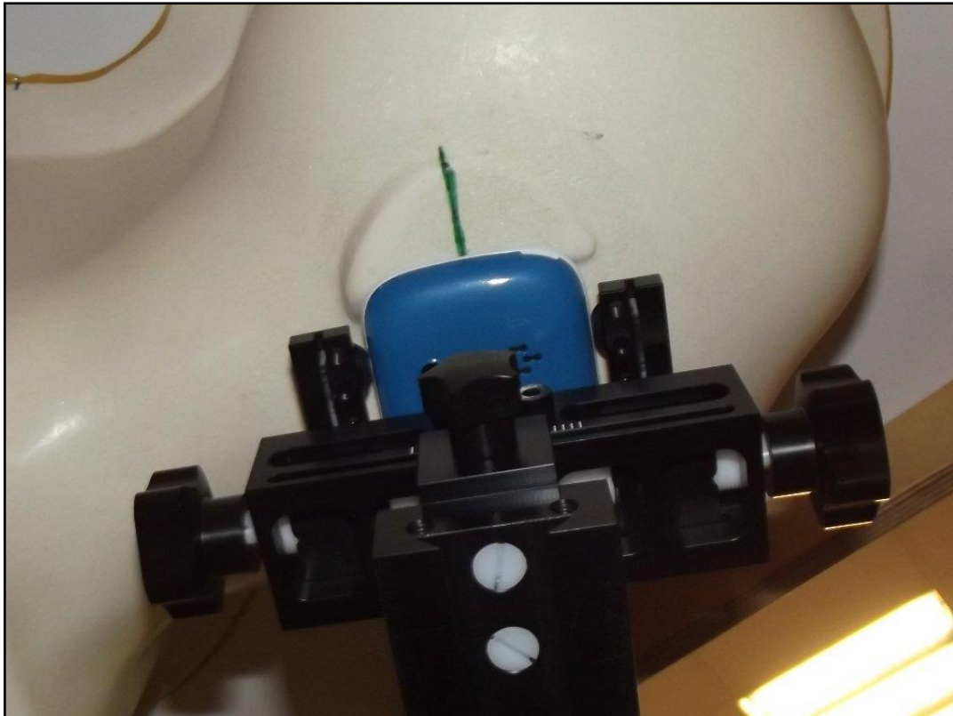
Photo 15: Position d'essai main droite, contre la joue
