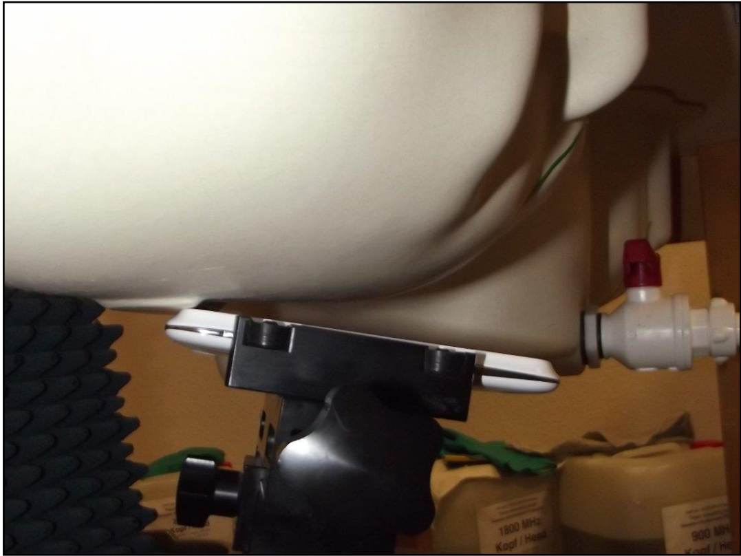
Photo 17: Position d'essai main droite, incliné 15°
