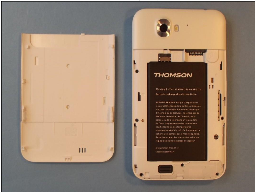
Photo 6: EST – vue arrière (ouvert) sans batterie
