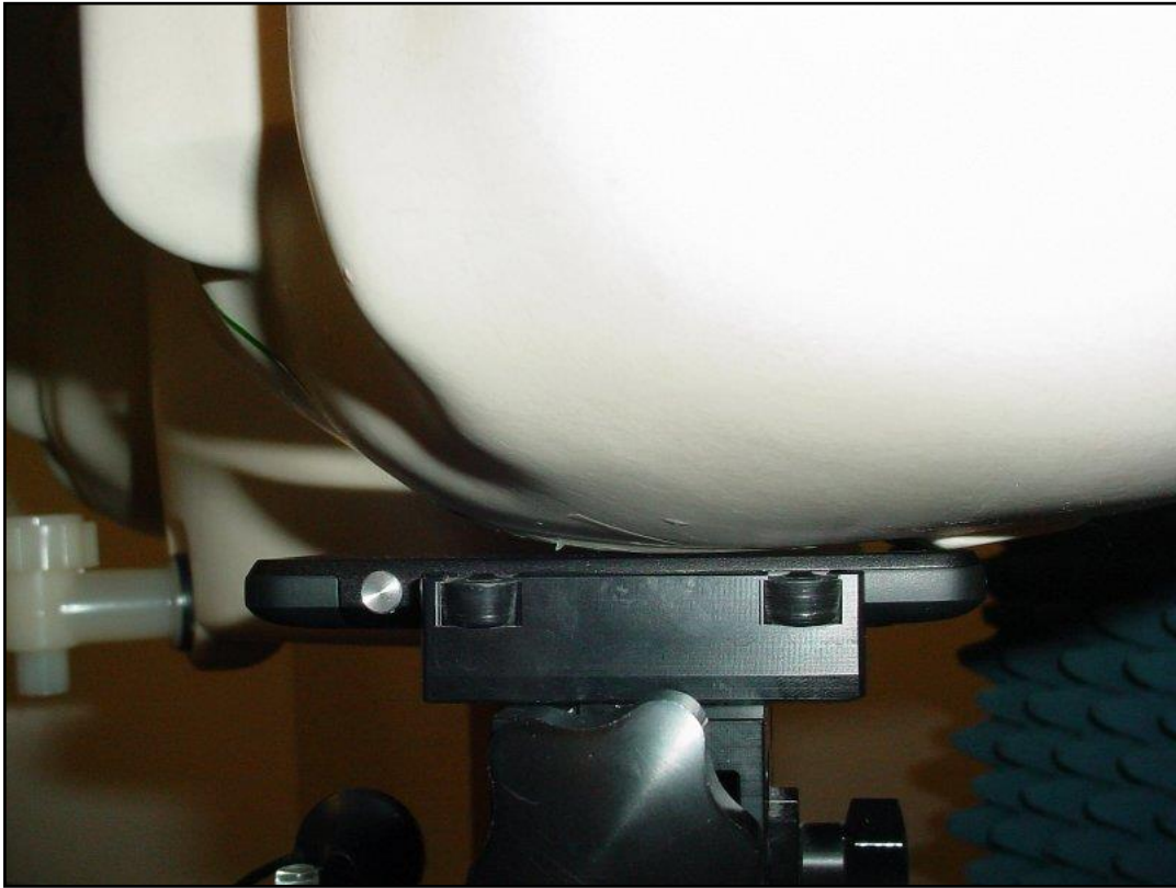
Photo 10: Position d'essai main gauche, contre la joue
