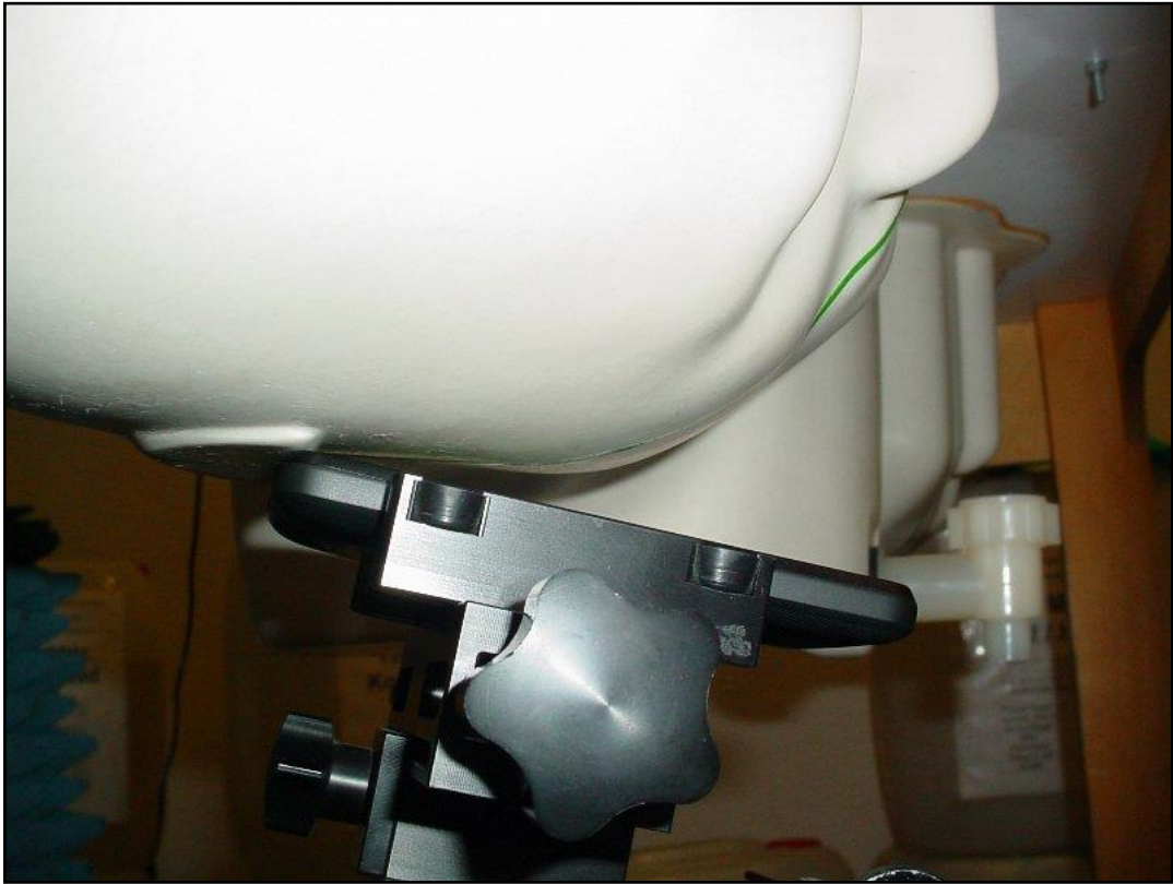
Photo 17: Position d'essai main droite, incliné 15°
