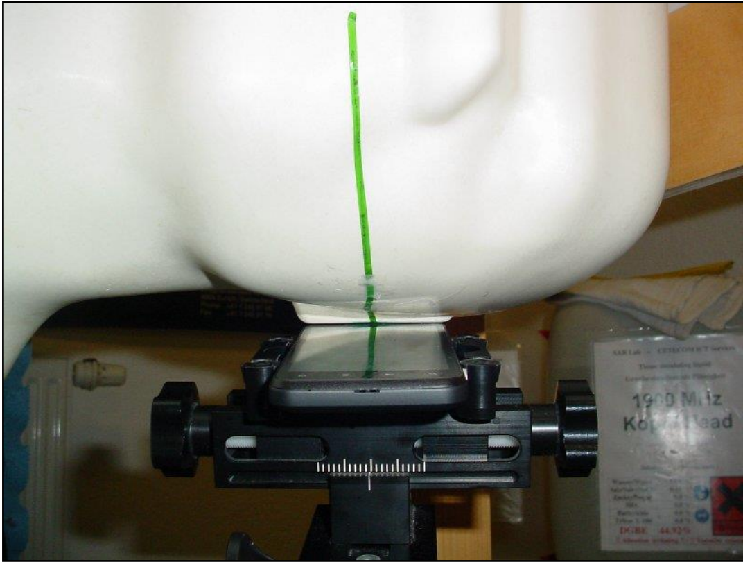
Photo 12: Position d'essai main gauche, incliné 15°
