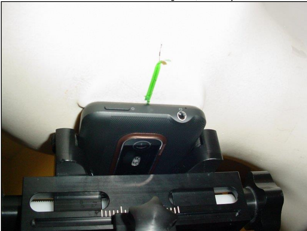
Photo 10: Position d'essai main gauche, contre la joue
