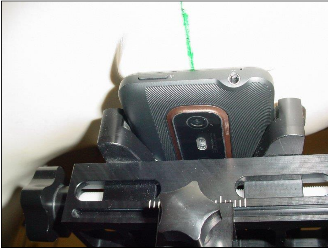
Photo 16: Position d'essai main droite, incliné 15°
