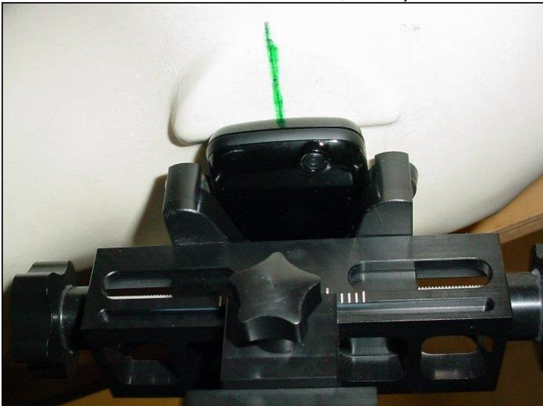
Photo 18: Position d'essai main droite, contre la joue
