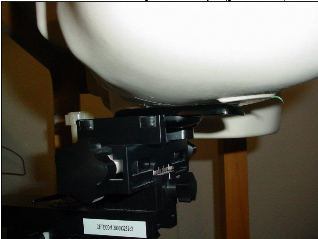
Photo 14: Position d'essai main gauche, contre la joue (glissière ouverte)
