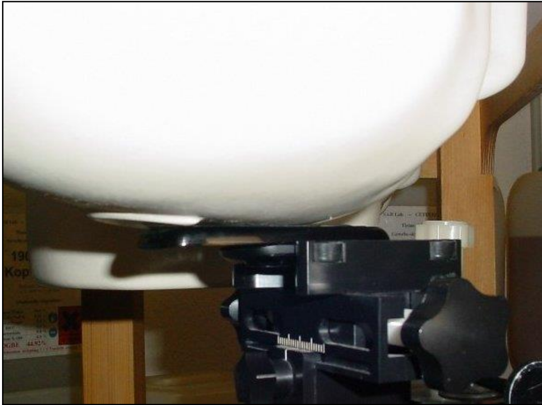
Photo 22: Position d'essai main droite, incliné 15° (glissière ouverte)
