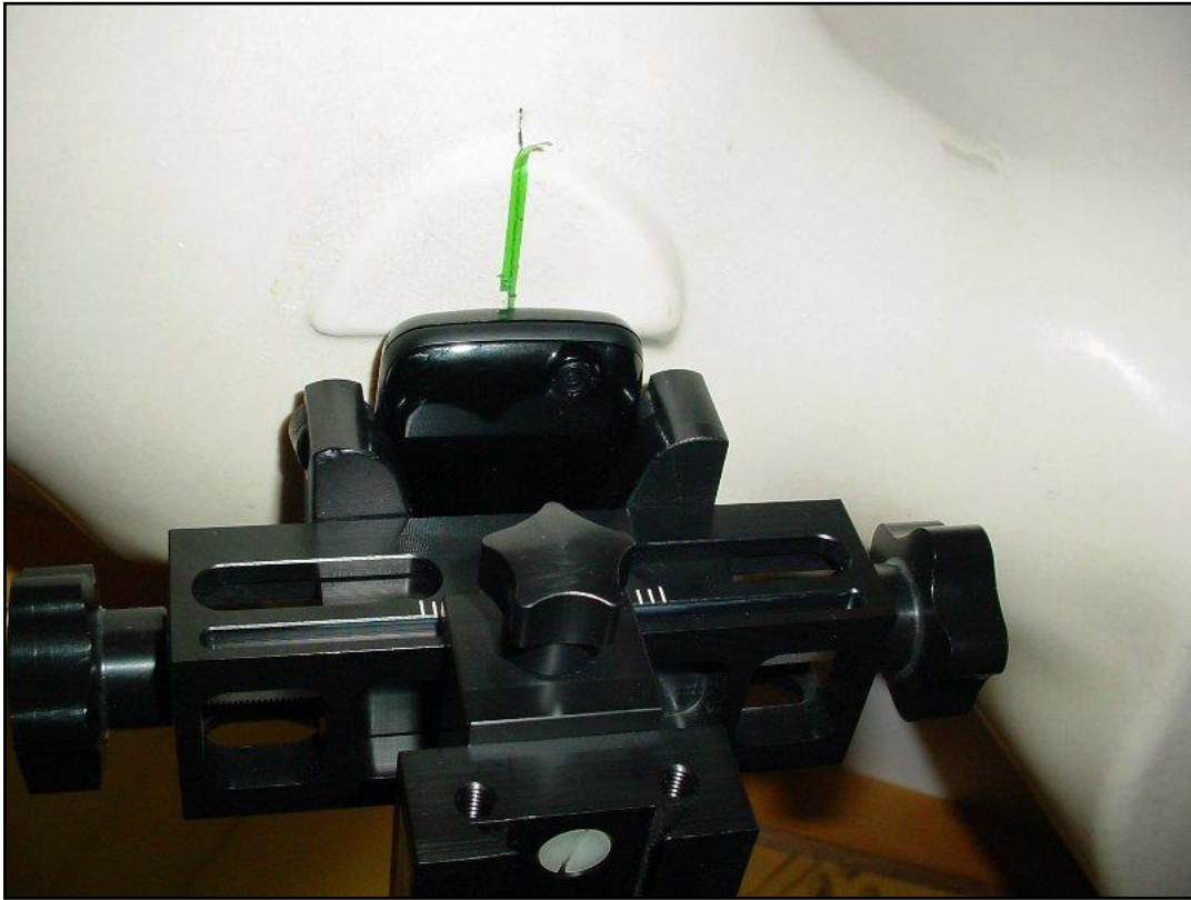
Photo 12: Position d'essai main gauche, incliné 15°
