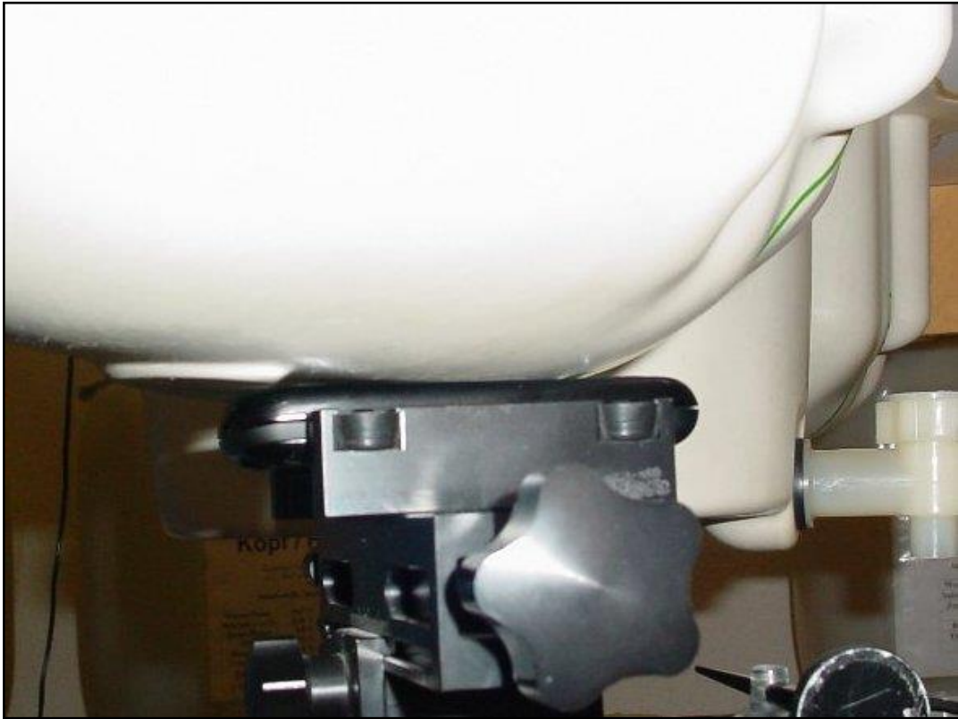
Photo 18: Position d'essai main droite, contre la joue
