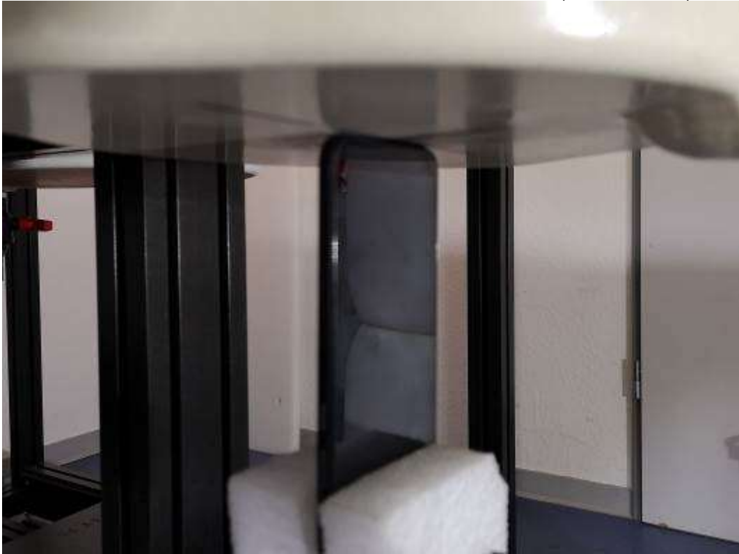
Photo 11: Position d'essai face du dessous contre le membre (distance 0 mm)
