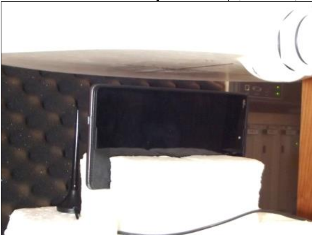
Photo 10: Position d'essai face du côté gauche contre le corps (distance 15 mm)
