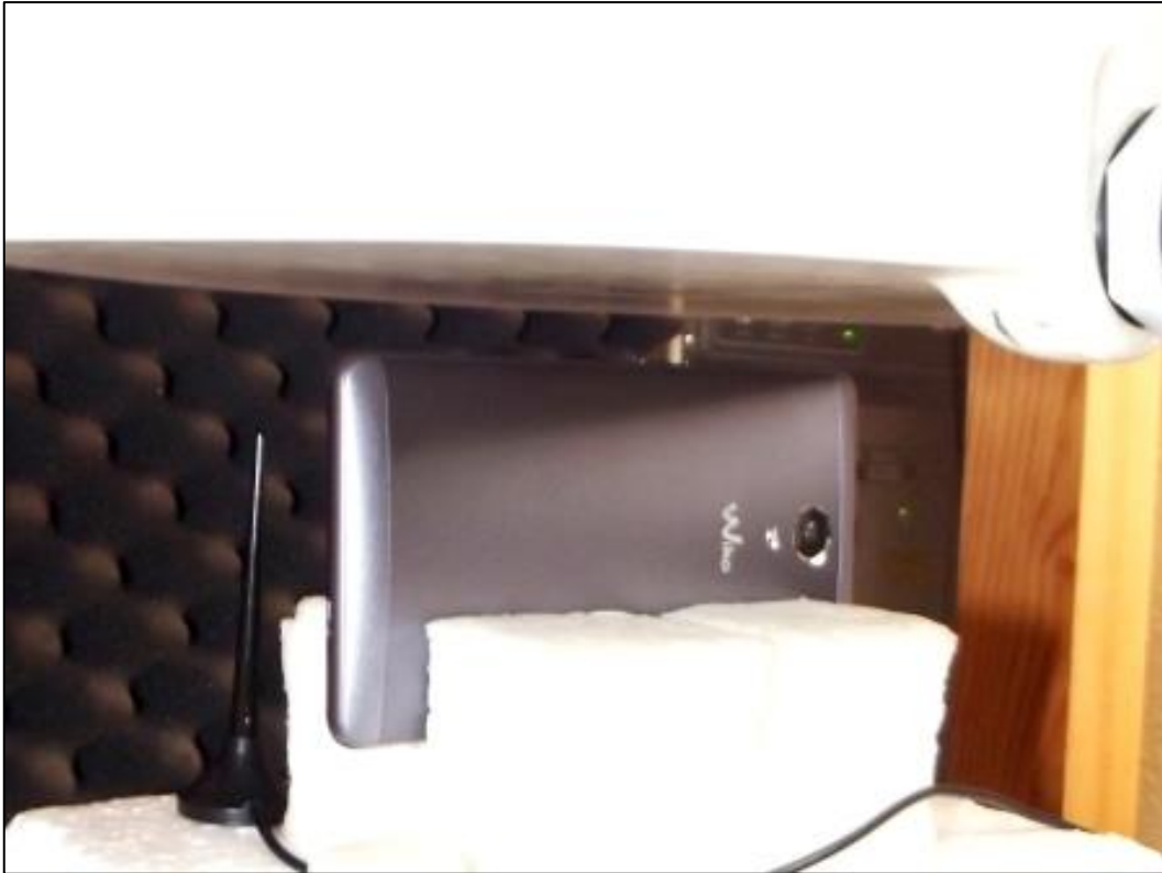
Photo 11: Position d'essai face du côté droit contre le corps (distance 15 mm)
