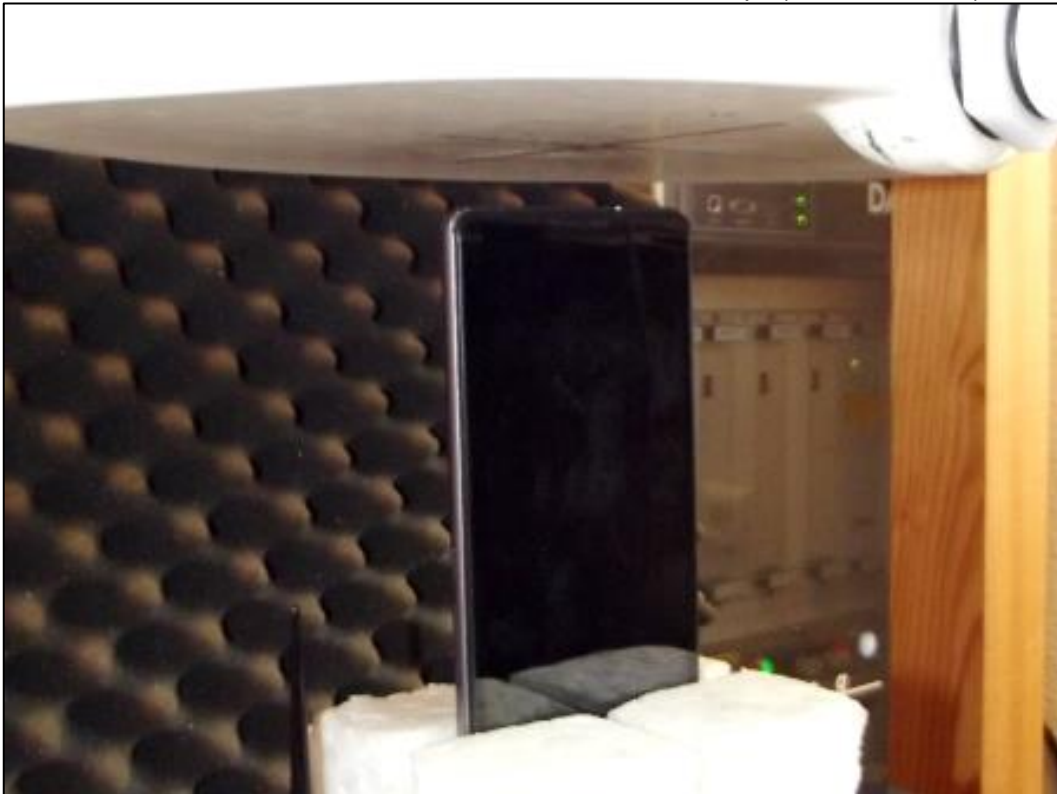
Photo 12: Position d'essai face du dessous contre le corps (distance 15 mm)
