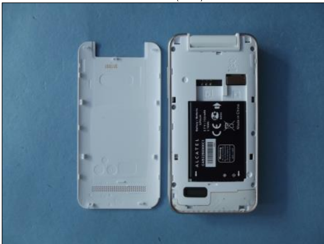
Photo 7: EST – vue arrière (ouvert) avec batterie
