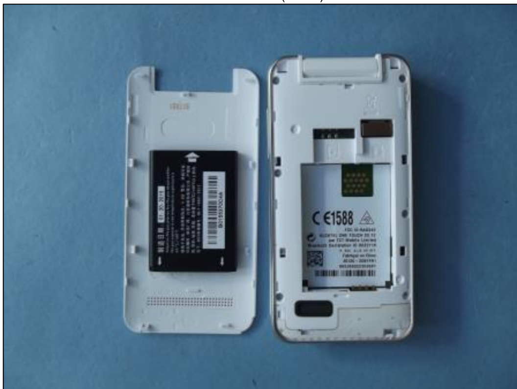
Photo 8: EST – vue arrière (ouvert) sans batterie
