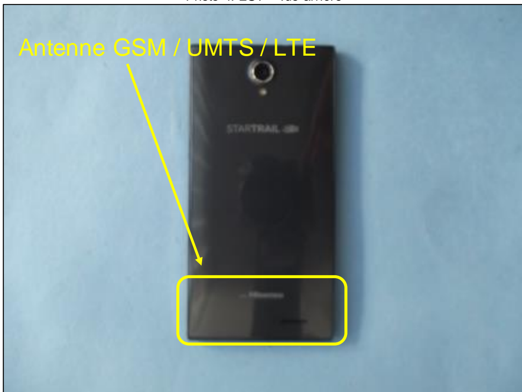
Photo 4: EST – vue arrière
