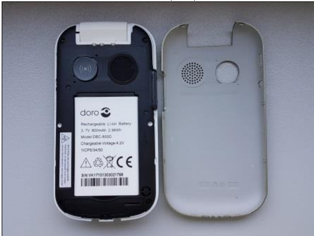
Photo 5: EST – vue arrière (ouvert) avec batterie
