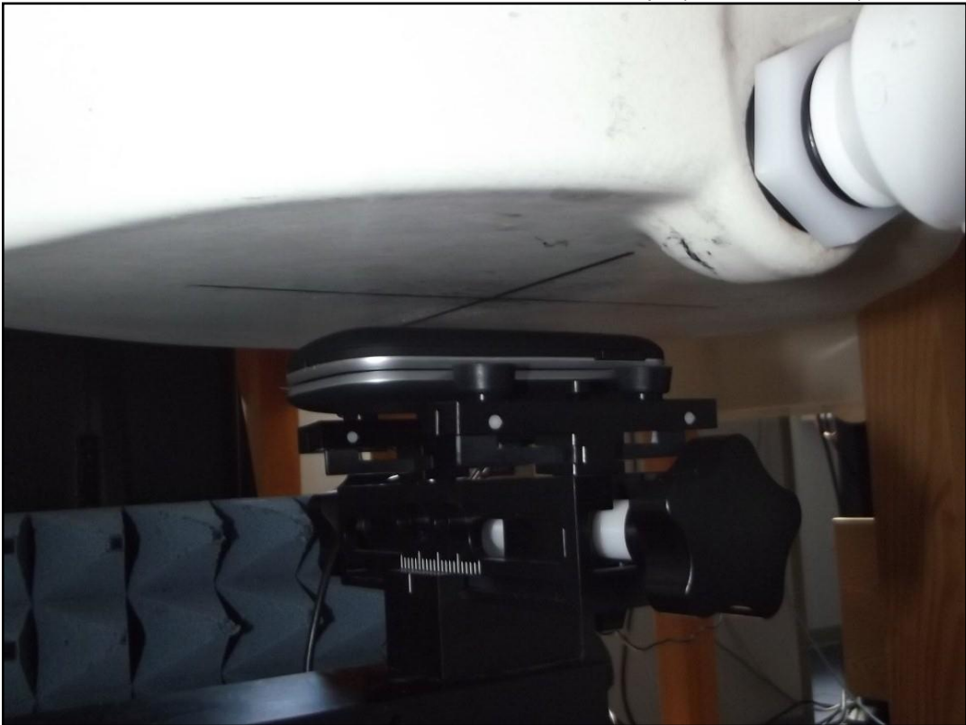
Photo 13: Position d'essai face arrière contre le corps (distance 10 mm)
