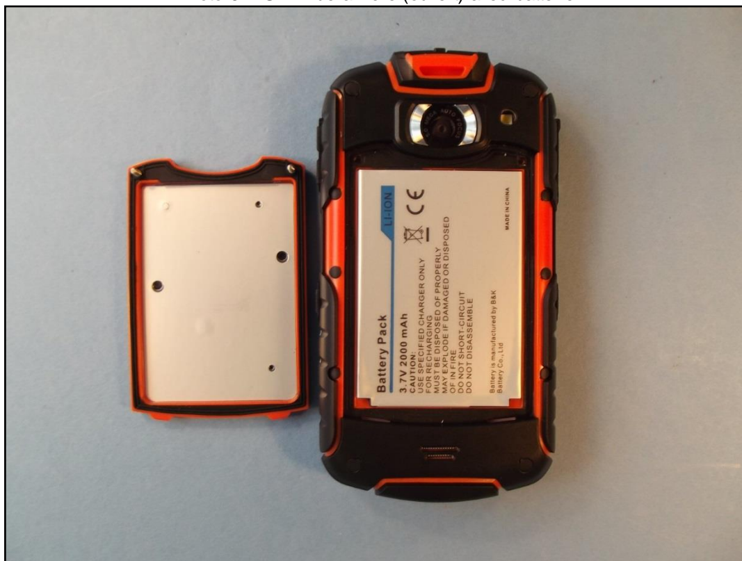
Photo 5: EST – vue arrière (ouvert) avec batterie
