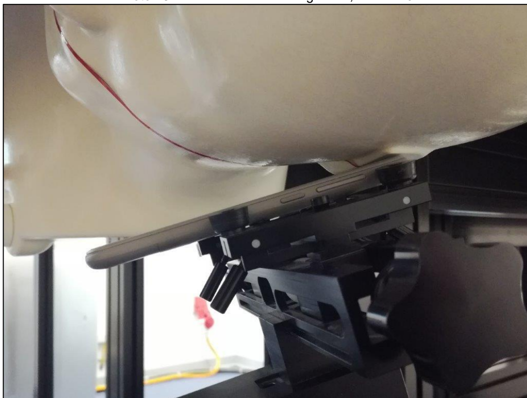
Photo 13: Position d'essai main gauche, incliné 15°
