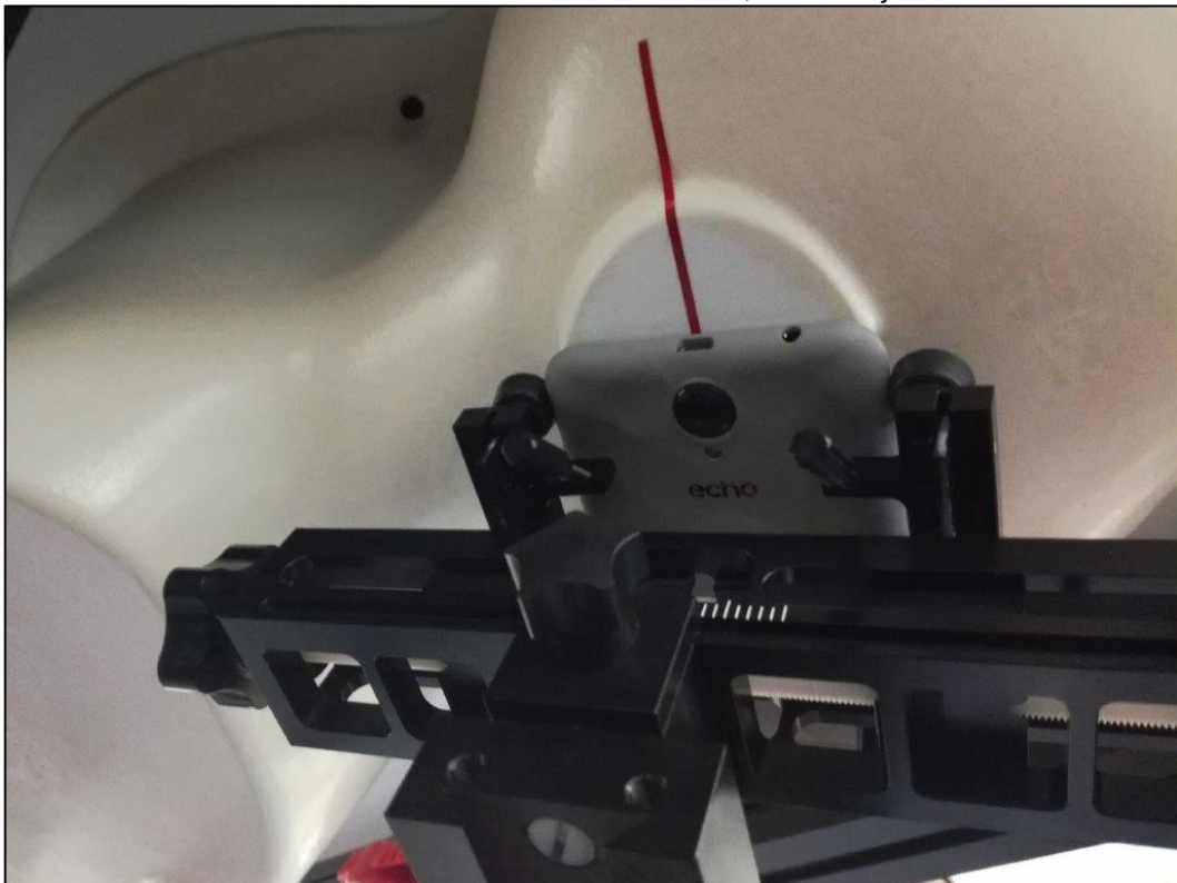
Photo 16: Position d'essai main droite, contre la joue
