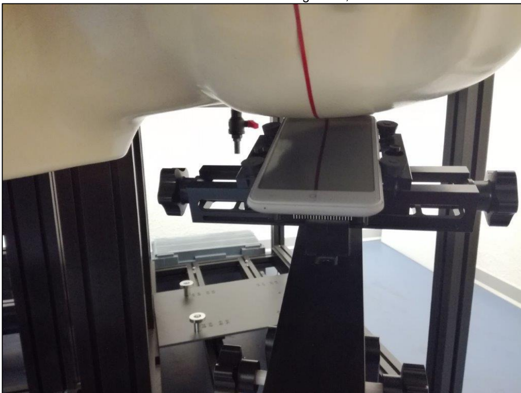
Photo 12: Position d'essai main gauche, incliné 15°
