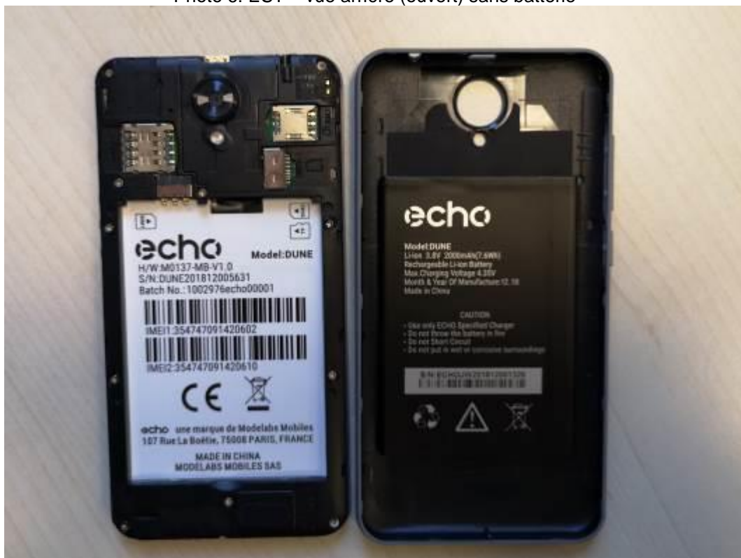
Photo 6: EST – vue arrière (ouvert) sans batterie
