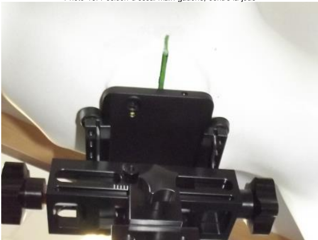
Photo 10: Position d'essai main gauche, contre la joue
