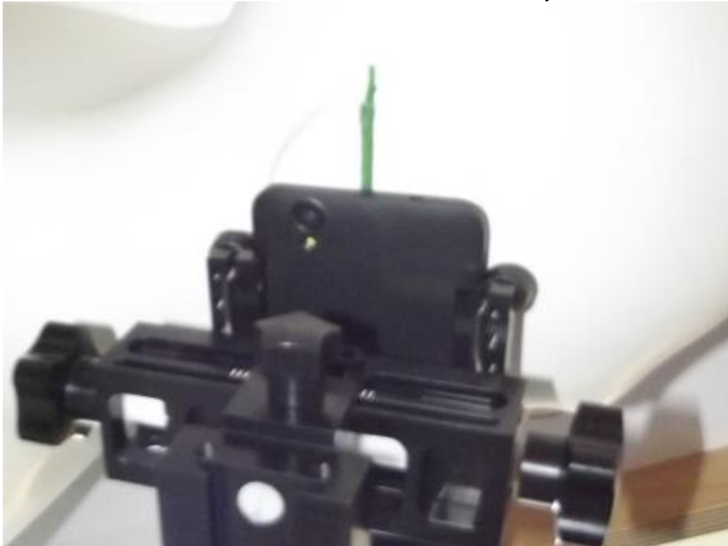
Photo 16: Position d'essai main droite, incliné 15°
