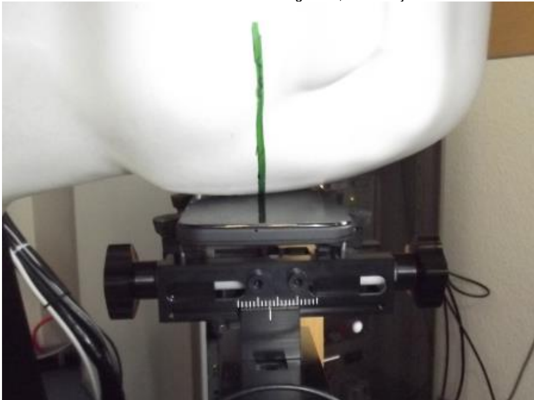
Photo 8: Position d'essai main gauche, contre la joue
