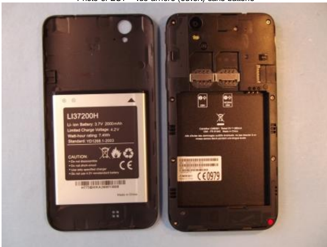
Photo 6: EST – vue arrière (ouvert) sans batterie
