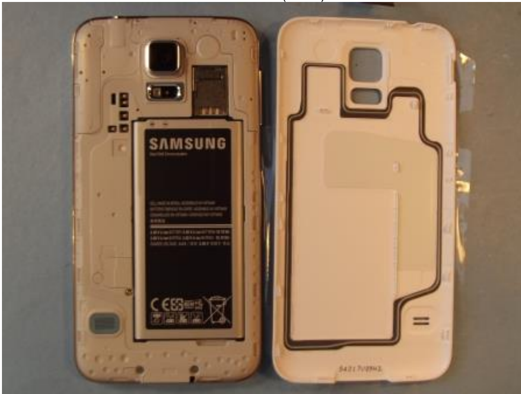
Photo 6: EST – vue arrière (ouvert) sans batterie
