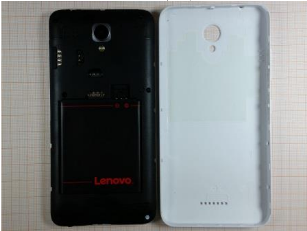
Photo 6: EST – vue arrière (ouvert) sans batterie
