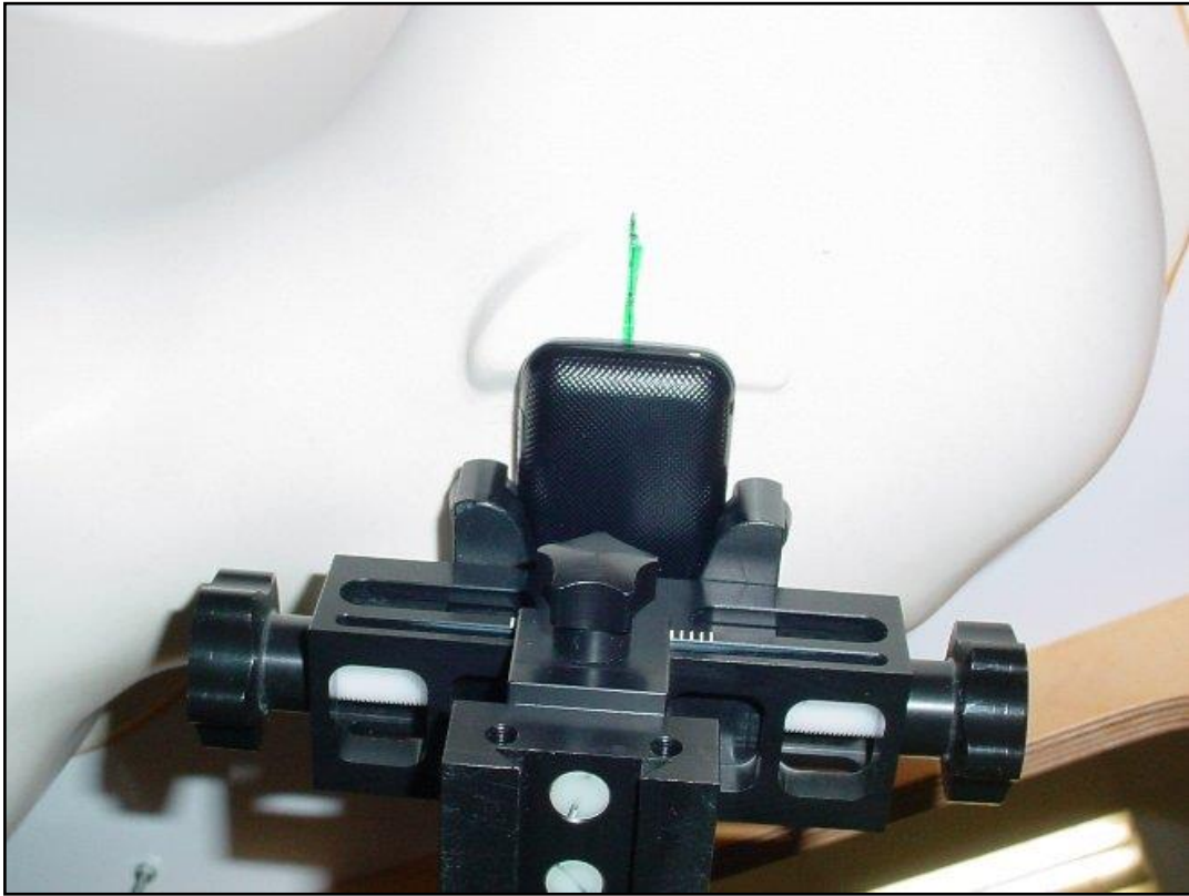
Photo 16: Position d'essai main droite, incliné 15°
