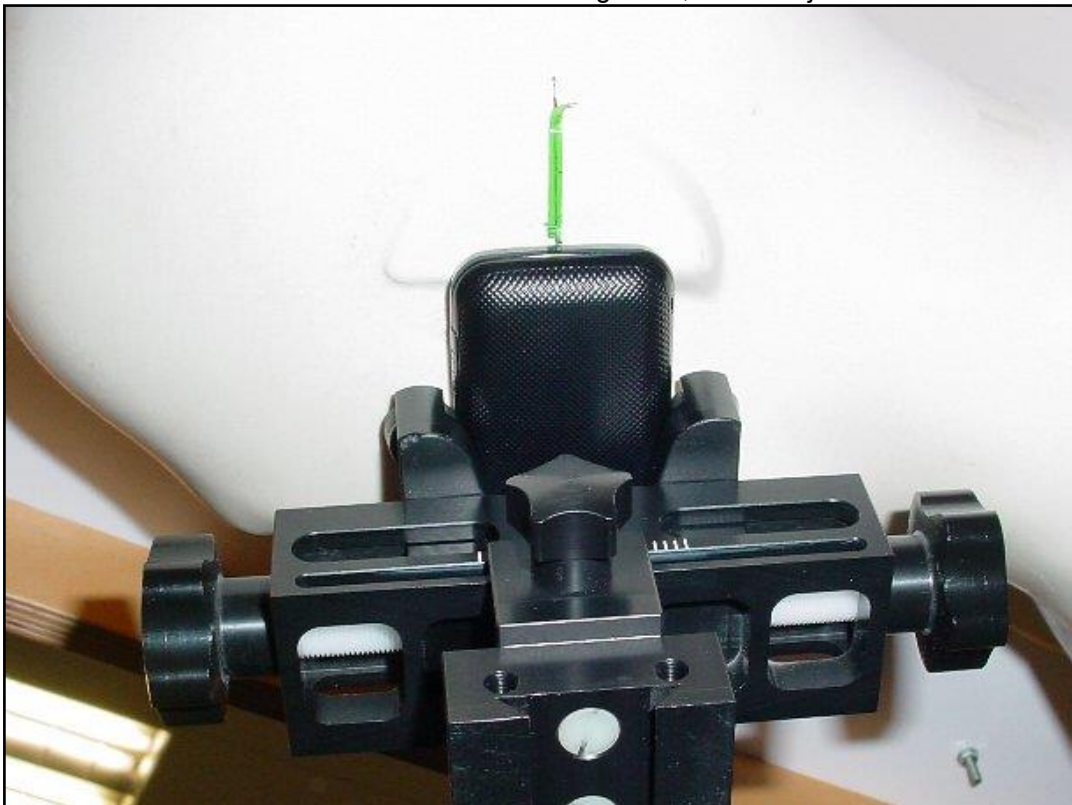
Photo 10: Position d'essai main gauche, contre la joue
