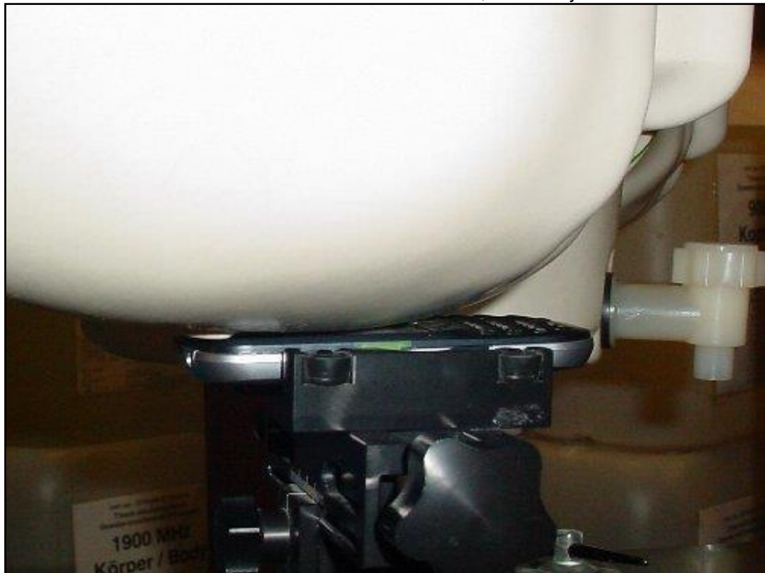
Photo 14: Position d'essai main droite, contre la joue
