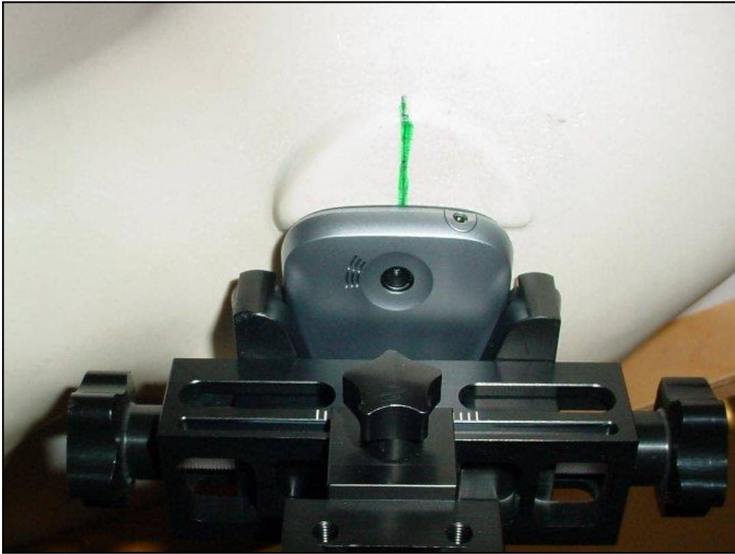
Photo 16: Position d'essai main droite, incliné 15°
