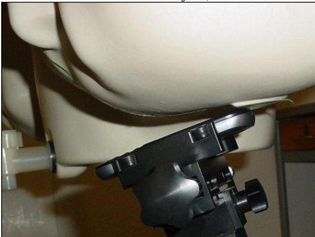
Photo 12: Position d'essai main gauche, incliné 15°
