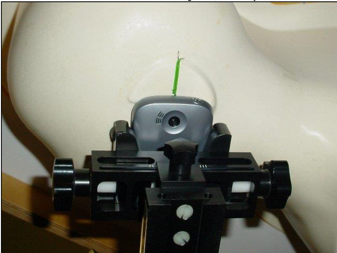
Photo 10: Position d'essai main gauche, contre la joue
