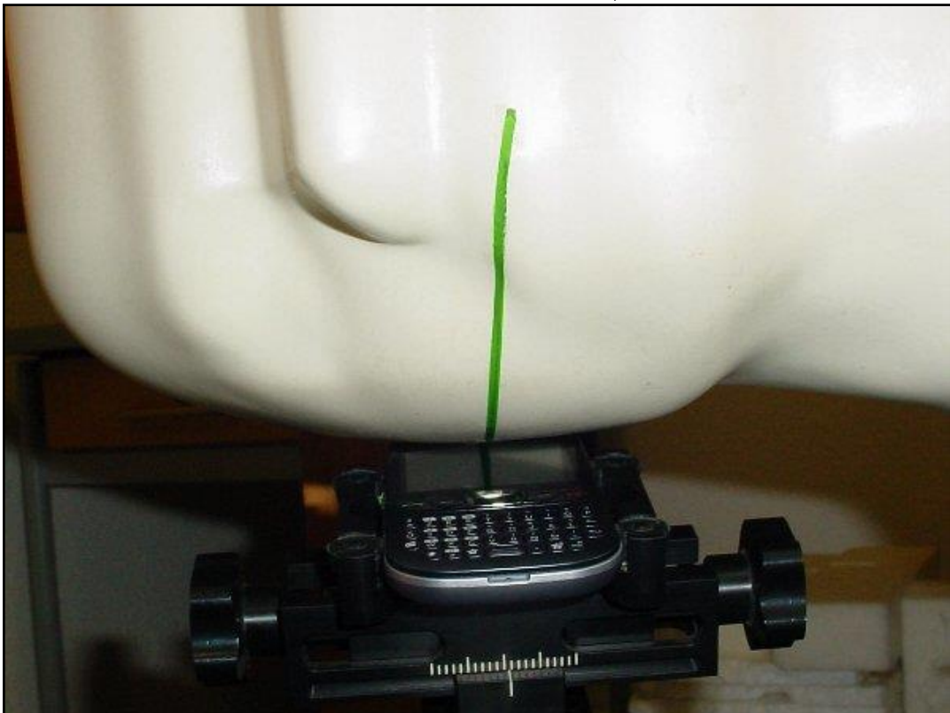
Photo 16: Position d'essai main droite, incliné 15°
