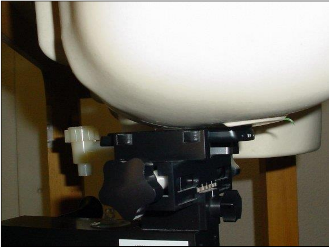
Photo 10: Position d'essai main gauche, contre la joue
