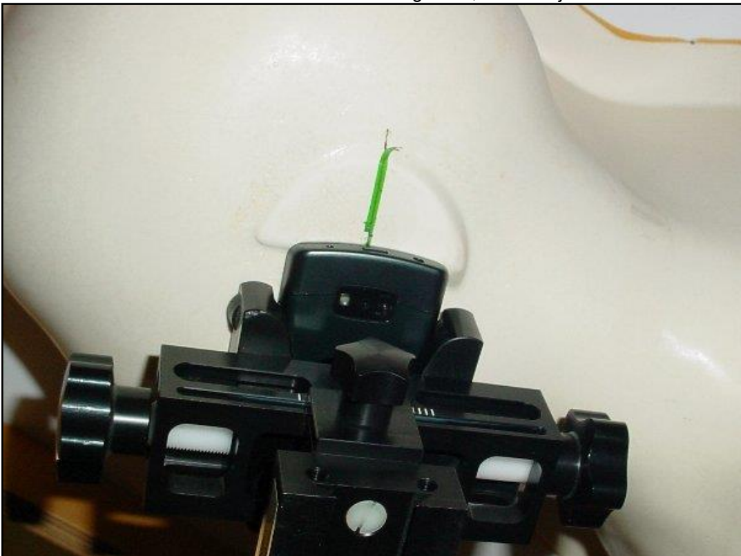
Photo 10: Position d'essai main gauche, contre la joue
