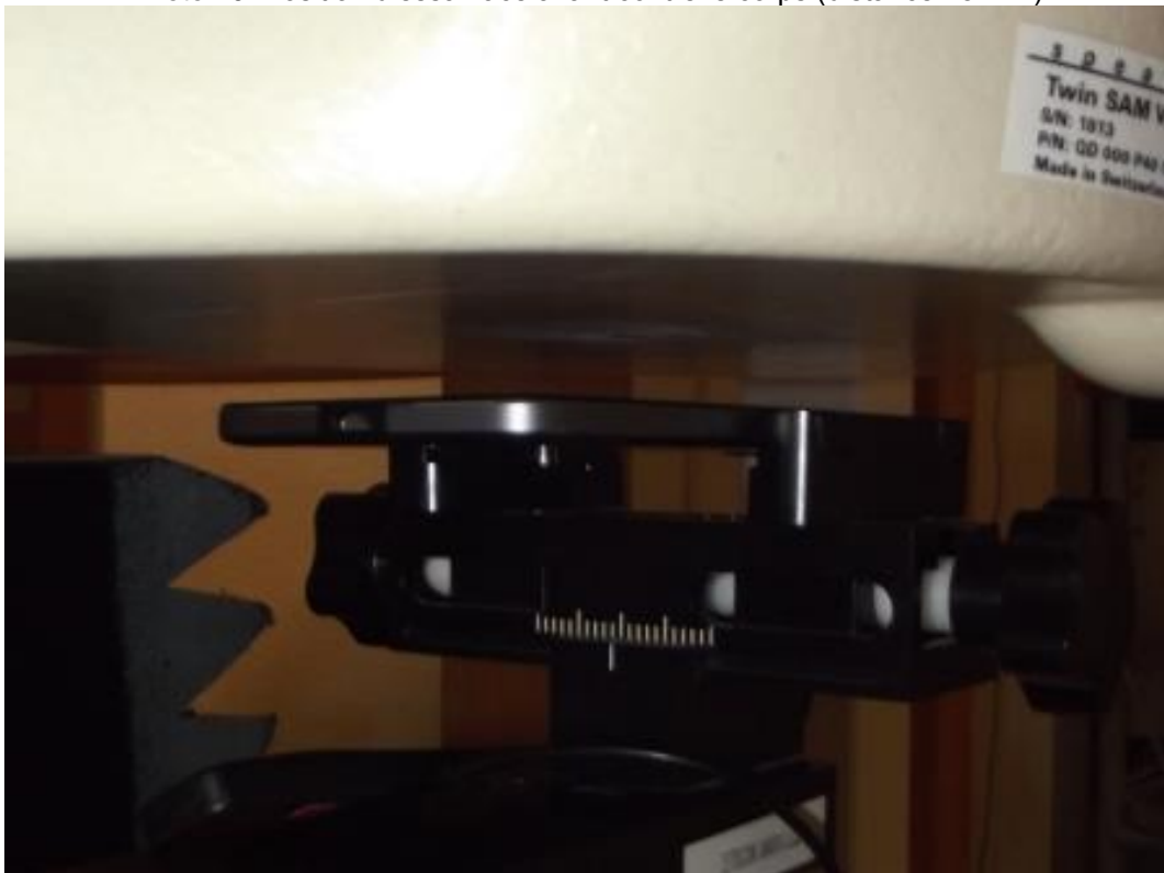
Photo 10: Position d'essai face avant contre le corps (distance 15 mm)
