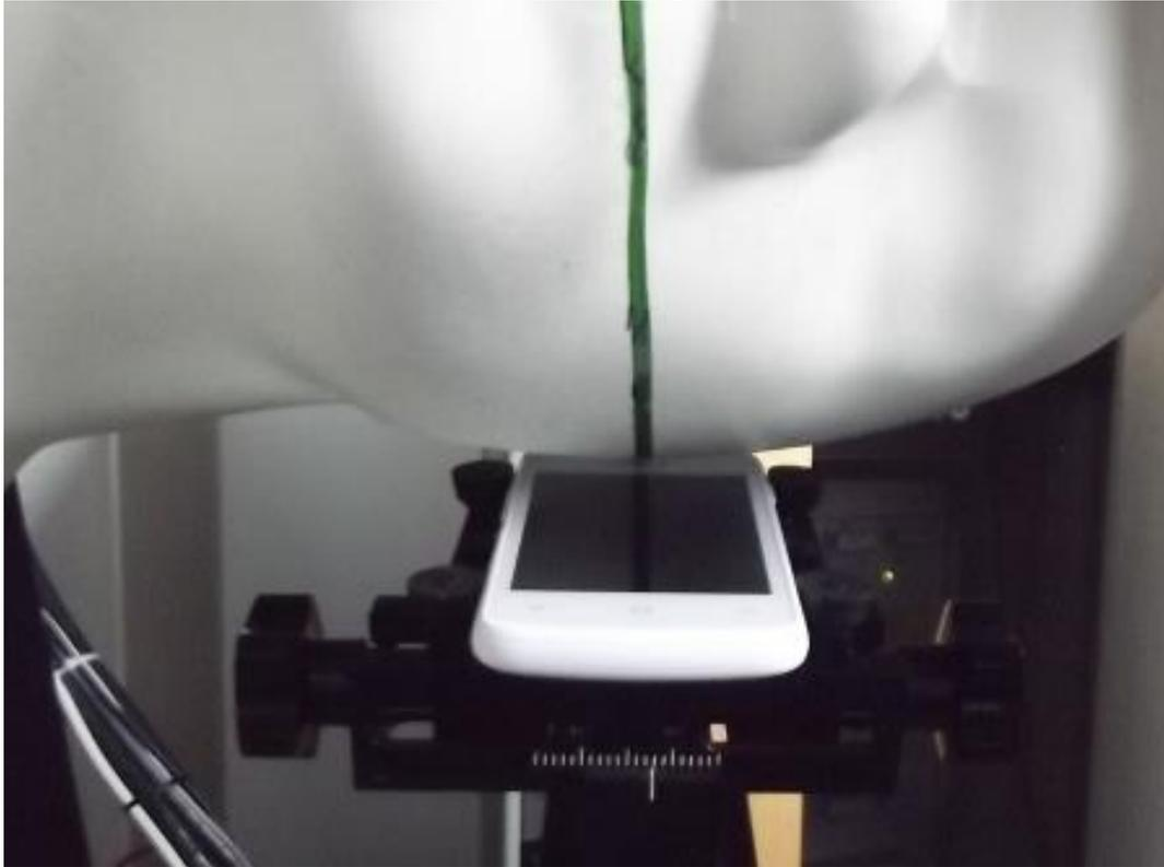
Photo 12: Position d'essai main gauche, incliné 15°
