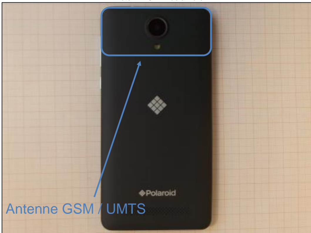
Photo 4: EST – vue arrière
