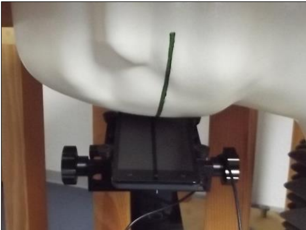
Photo 16: Position d'essai main droite, incliné 15°
