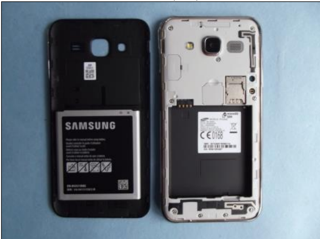
Photo 6: EST – vue arrière (ouvert) sans batterie
